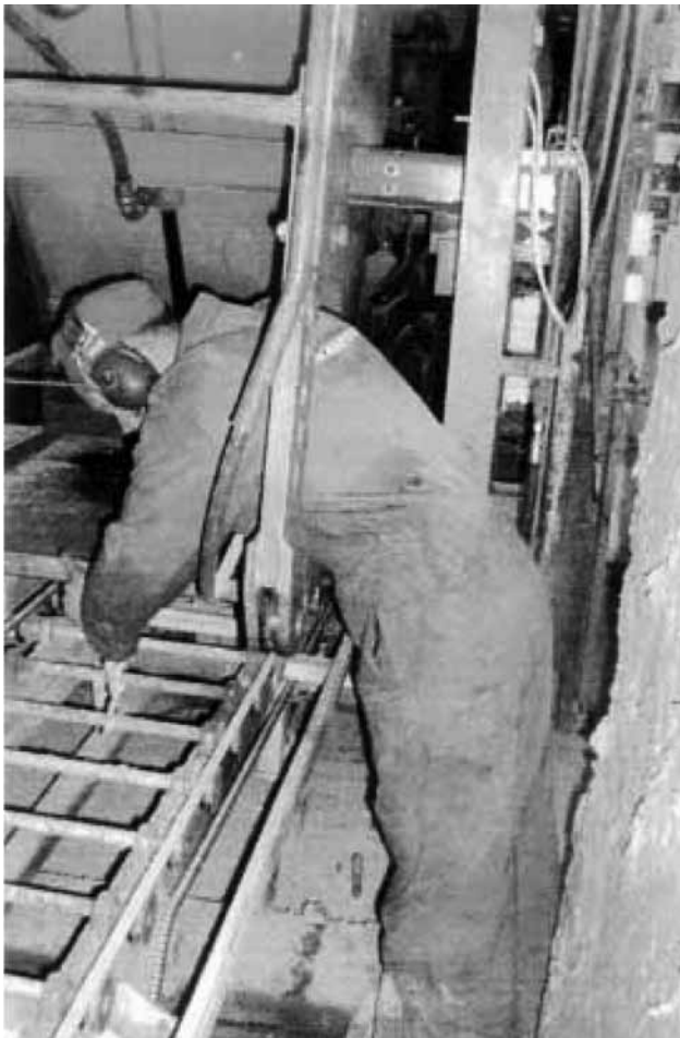
Kuva 2. Lavastettu tilanne puristumisesta siirtovarsien ja koneen rungon väliin
