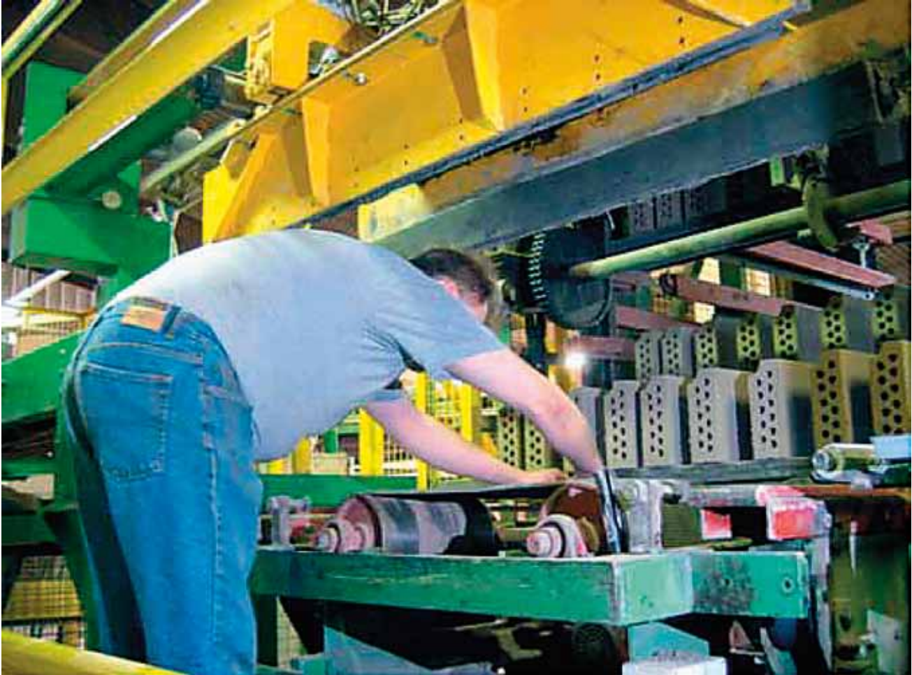
Kuva 1. Menehtynyt työskenteli alas laskeutuvan tarttujan alla ja jäi sen alle puristukseen.
