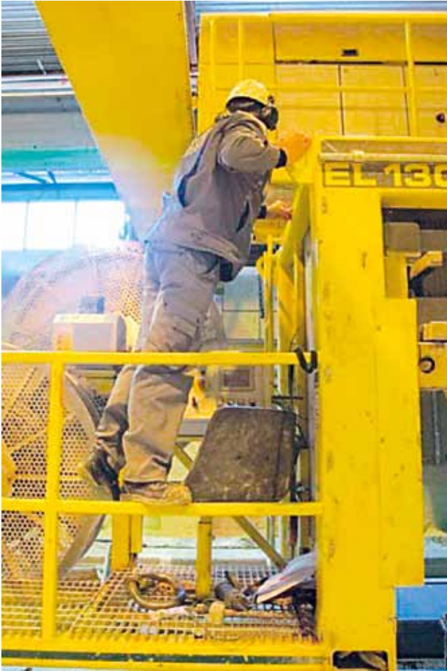
Kuva 2. Lavastettu tilanne siitä, miten NN seiso tapaturmahetkellä tuolin päällä. Henkilön pään vasemmalla puolella välikuljettimen palkki, jonka liikenopeus oli 0,7 m/s.
