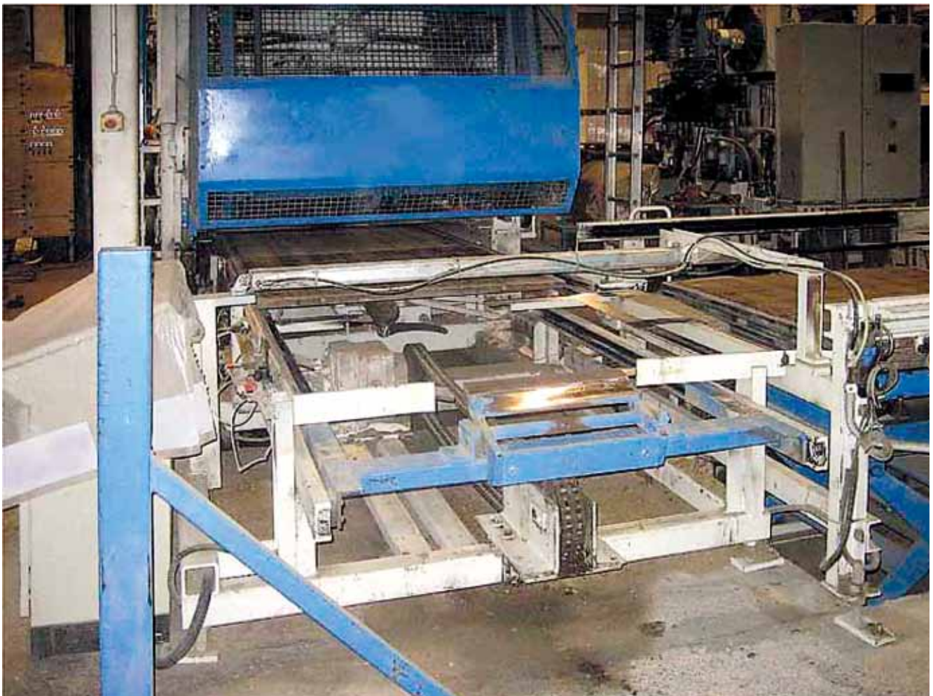
Kuva 4. Menehtynyt puristui alaruumiistaan kuljetinpyöden ja koneen rungon väliin.
