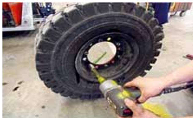
12. Kiinnitä vanteen puoliskot toisiinsa.
