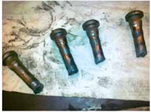
Kuva 3. Vanteen pultit ovat vaurioituneet pahoin kun ajon aikana pultit ovat olleet löysällä.
