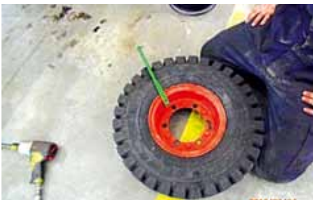
13. Laita uusi neula ja lukitse se paikalleen.
