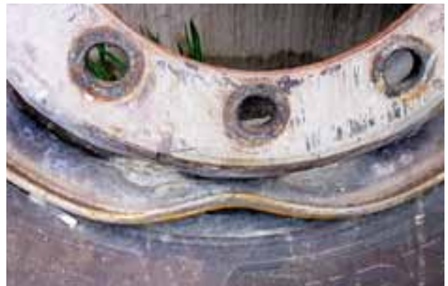
Kuva 3. Ajon aikan vaurioitunut vanteen reuna, mikä johtaa vanteen hylkäämiseen.
