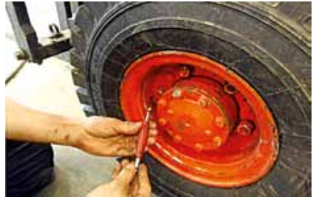
2. Poista renkaasta venttiilineula. HUOM. Rengasta ei saa koskaan irrottaa paineellisenä.
