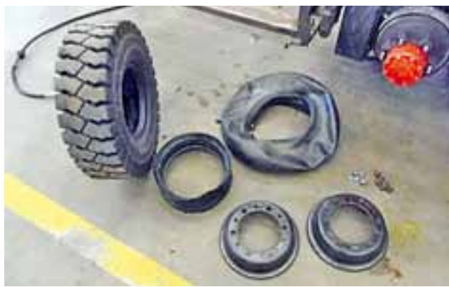
8. Sisärengas ja vannenauha on irrotettu. Puhdista ne osat jotka asennat takaisin.
