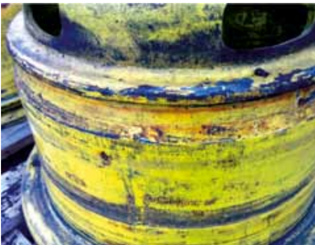
Kuva 5 Lukkovanteen vaurioitunut lukkoura ja liiksi ruostunut lukkovanne johtavat vanteiden hylkäämiseen.
