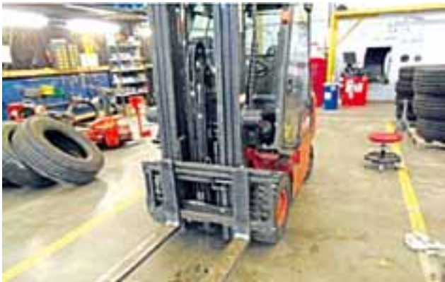
1. Pysäköi trukki turvallisesti tasaiselle paikalle. Laske haarukka alas.
