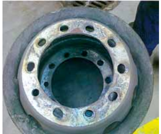
Kuva 5. Vanne, jonka pultinreiät ovat soikeat, koska pultit ovat olleet ajon aikana löysällä. Tällainen vanne on romutettava.
