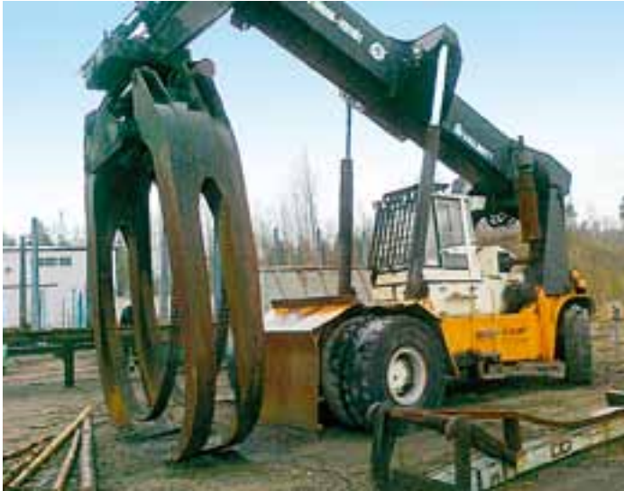
Kuva 2. Teollisuudessa yleisesti käytetyn kurottajan renkaat ja vanteet joutuvat kovalle kuormitukselle.
