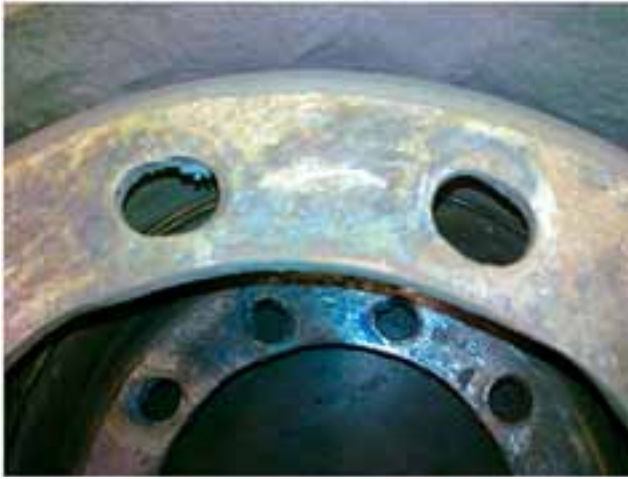
Kuva 2. Vanteen pulttien reiät ovat tulleet soikeanmuotoisiksi kun ajon aikana pultit ovat olleet löysällä.
