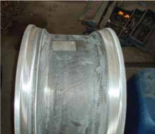
Kuva 4. Vanteen kulunut vastepinta voi johtaa vanteen hylkäämiseen.
