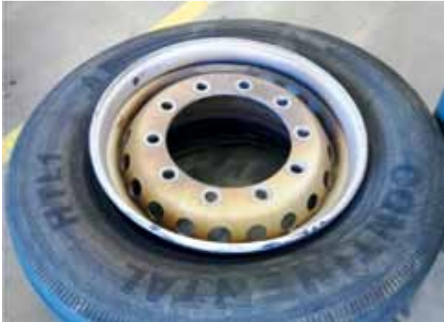
Kuva 2. Ylikuumentunut vanne kun pyörän laakeri oli hirttänyt kiinni johtaa hylkäämiseen. Vanteen laipassa on havaittavissa selvä värimuutos.
