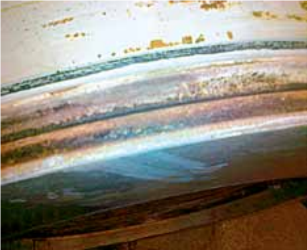
Kuva 4. Tykkipyörän lukkovanteen ura eikä takavaste kestä hakkaamista metallisella työkalulla.
