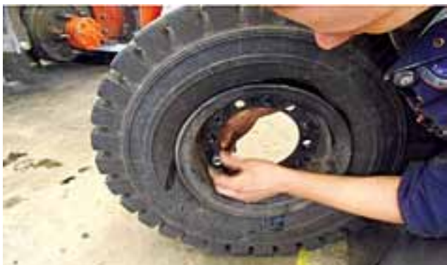
11. Asenna toinen vanteen puolisko renkaaseen.
