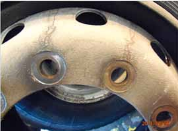
Kuva 1. Kun vanteen pultit ovat olleet löysällä ajon aikana, on vanteeseen jäänyt sadekelillä kuvan mukaiset pulttien juurista lähtevät valumisraidat. Toinen merkki pyörän muttereiden löysyydestä on laippamutterin ja vanteen yhtymäkohtaan ajon aikana tullut ohut ja kirkas hiertymäjälki.
