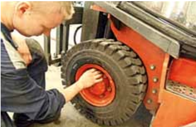
17. Tarkista, että venttiili ei vuoda. Laita venttiilin hattu paikalle.
