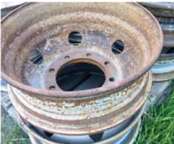
Kuva 1. Tyypillinen kauttaaltaan ruostunut kuorma-auton vanne, joka tulisi kunnostaa tai romuttaa.
