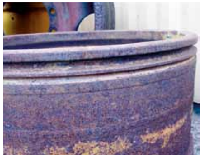
Kuva 5 Lukkovanteen vaurioitunut lukkoura ja liiksi ruostunut lukkovanne johtavat vanteiden hylkäämiseen.
