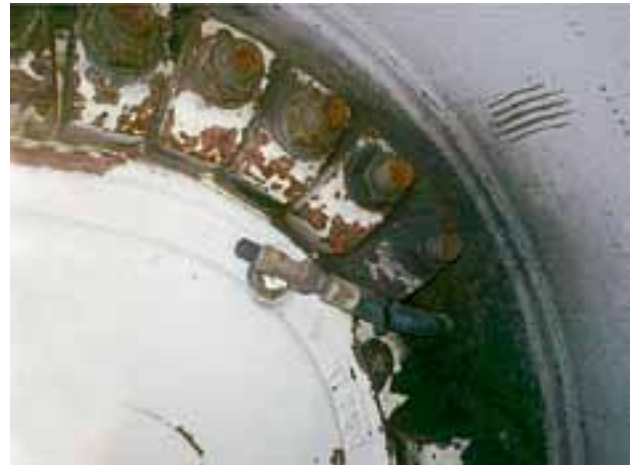
Kuva 3. Kurottajatruckin tykkipyörien kiinnitystavat voivat olla erilaisia. Oikeassa kuvassa venttiilin jatke on asennettu oikein, siitä renkaasta on helppo poistaa paine.
