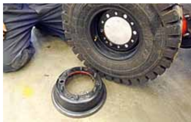
10. Aseta vannenauha ja vanteen toinen puolisko renkaaseen.
