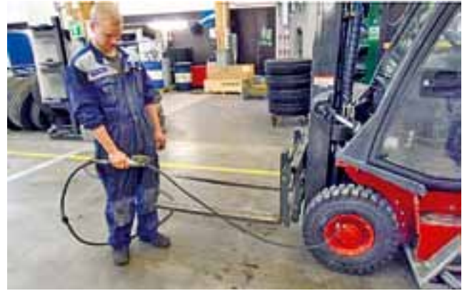
16. Täytä rengas VASTA tässä vaiheessa täyttöpaineseen vähintään 2 m päässä ja seisomalla renkaan kulutuspinnan puolella.
