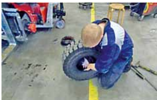
9. Asenna sisärengas renkaan sisään ja lukitse sen venttiili.
