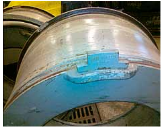
Kuva 4. Tykkipyörän lukkovanteen ura eikä takavaste kestä hakkaamista metallisella työkalulla.
