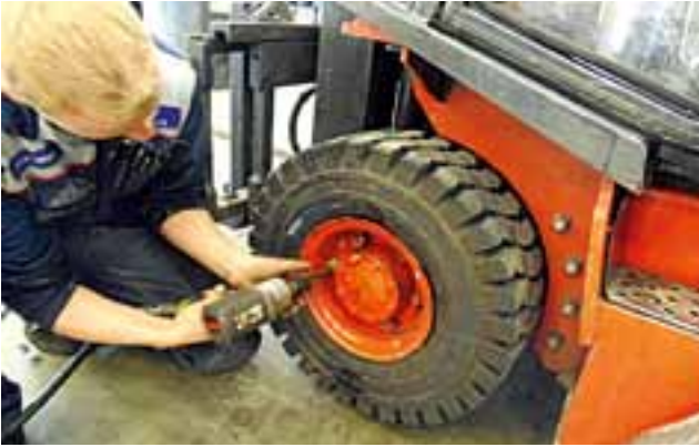
15. Kiinnitä varsinaiset pyöränpultit.
