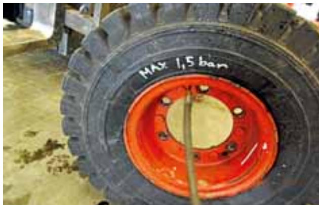
14. Laita renkaaseen hieman ilmaa, maksimissaan 1,5 bar.
