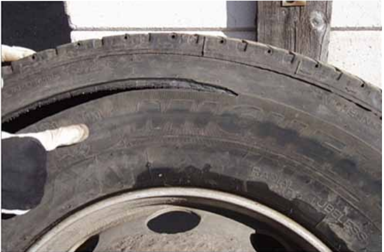
Kuva 2. Renkaan pinnassa ollut kulumisjälki (sormen kohdalla) ja osa pinnan repeämisjäljestä.
