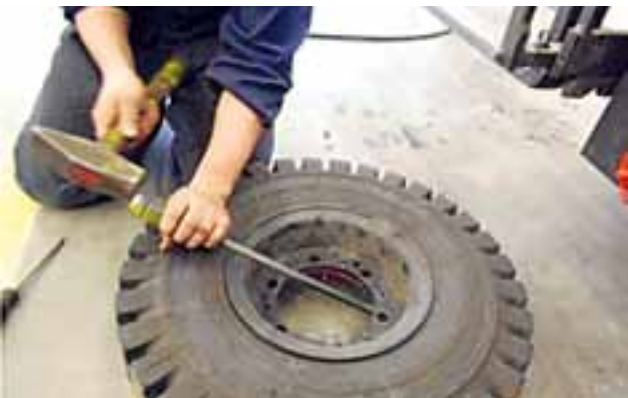
5. Irrota vanteen osat erilleen siihen soveltuvalla työkalulla.
