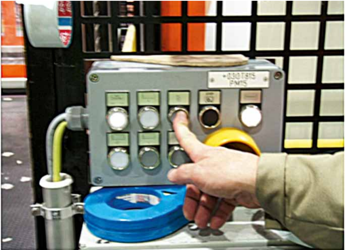
Kuva 2. Tapaturman jälkeen rullaston käyttö eri suuntiin on mahdollista ainoastaan painamalla jatkuvasti käynnistyskytkimiä, jolloin laitetta yksin käyttävä työntekijä ei yllä vaara-alueelle.
