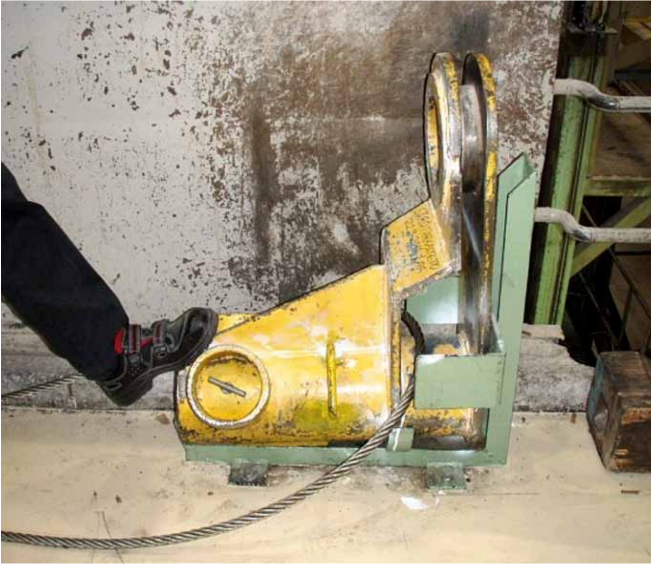
Kuva 2. Telan siirtoon käytetty nostoholkki tapaturman jälkeen. Nostovaijerin halkaisija oli 20mm.
