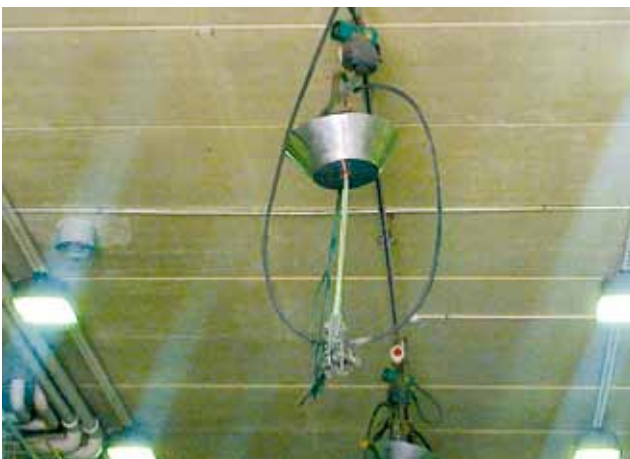
Kuva 2. Pesuryityksen käyttämä automaattinen pesurin pesupää kuljetussäiliötä varten.
