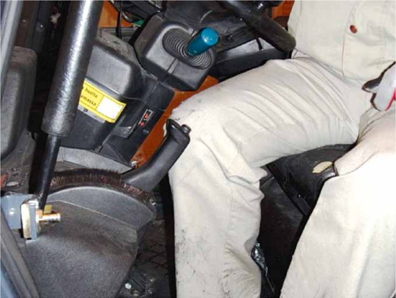
Kuva 1. Kuvan seisontajarru haittaa kuljettajan poistumista ohjaamosta, jos seisontajarru laitetaan päälle ennen ohjaamosta poistumista.
