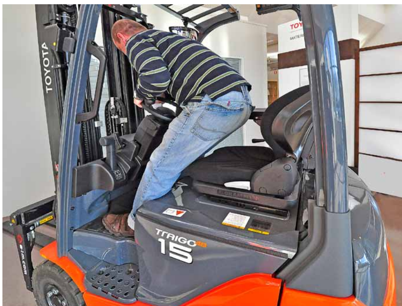
Kuva 2. Työkoneen istuimen alle voidaan sijoittaa anturi, joka hälyttää seisontajarrun käytöstä tai automaattisesti kytkee seisontajarrun, jos kuljettaja poistuu istuimeltaan.
