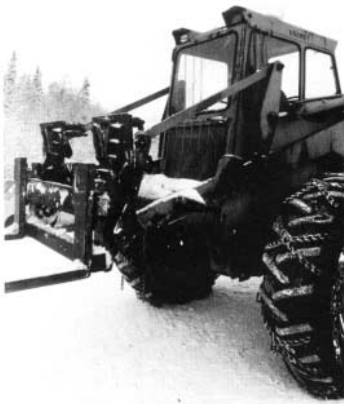
Kuva 2. Nostovarret asennossa, jossa olivat tapaturman sattuesssa.
