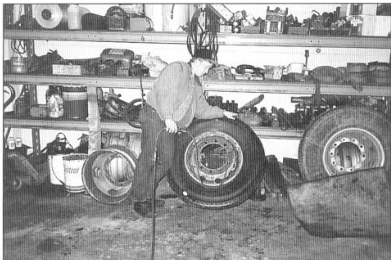
Kuva 1. Lavastettu kuva MN:n ja täytettävän renkaan asennosta juuri ennen renkaan räjähtämistä.
