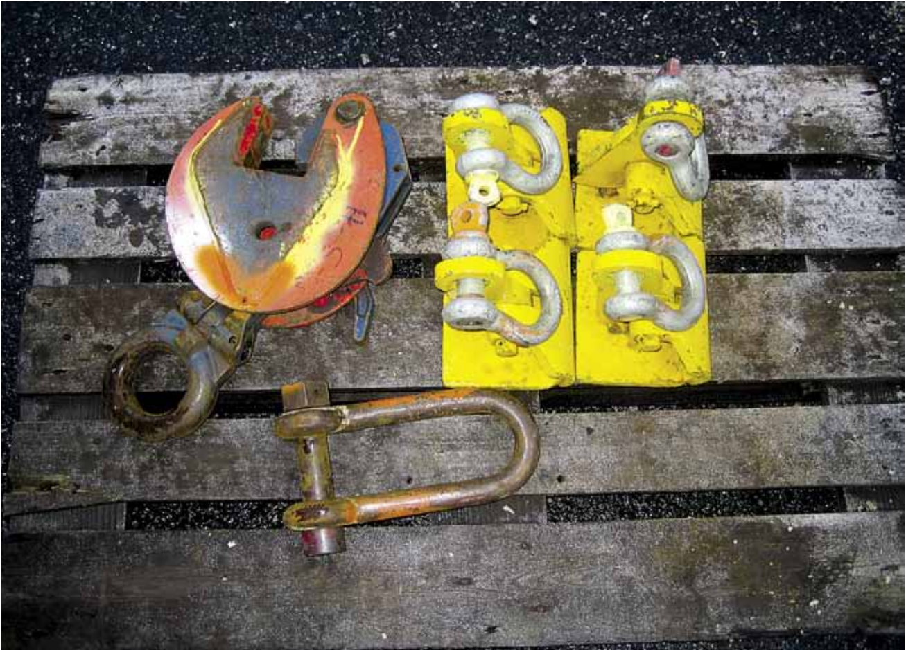
Kuva 2. Työssä käytetyt nostoapuvälineet: levytarrain (oranssi), vaakatarraimet (keltaiset) ja sakkeli (alinna).
