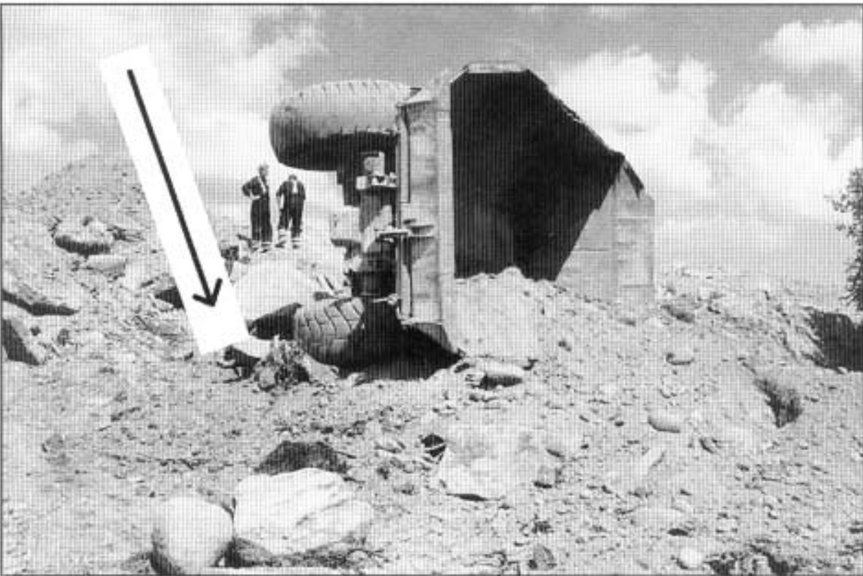
Kuva 2. Kaatunut dumperi. Nuoli osoittaa onnettomuuskohtaa. Vasemmassa yläkulmassa näkyvä kasa oli varsinainen kippauskohta.
