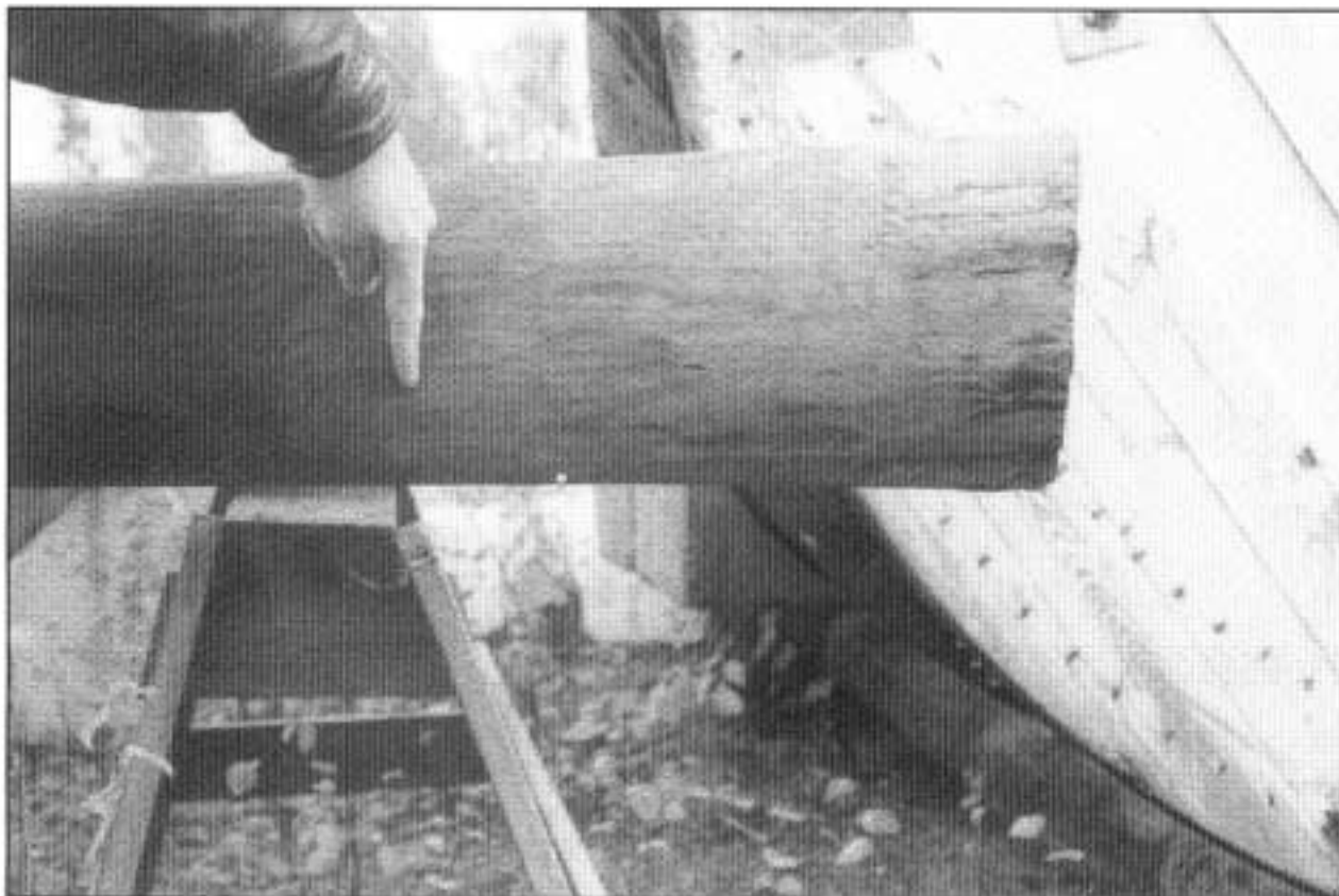
Kuva 3. Pylvään upotussyvyys rinteeseen yläpuolella.
