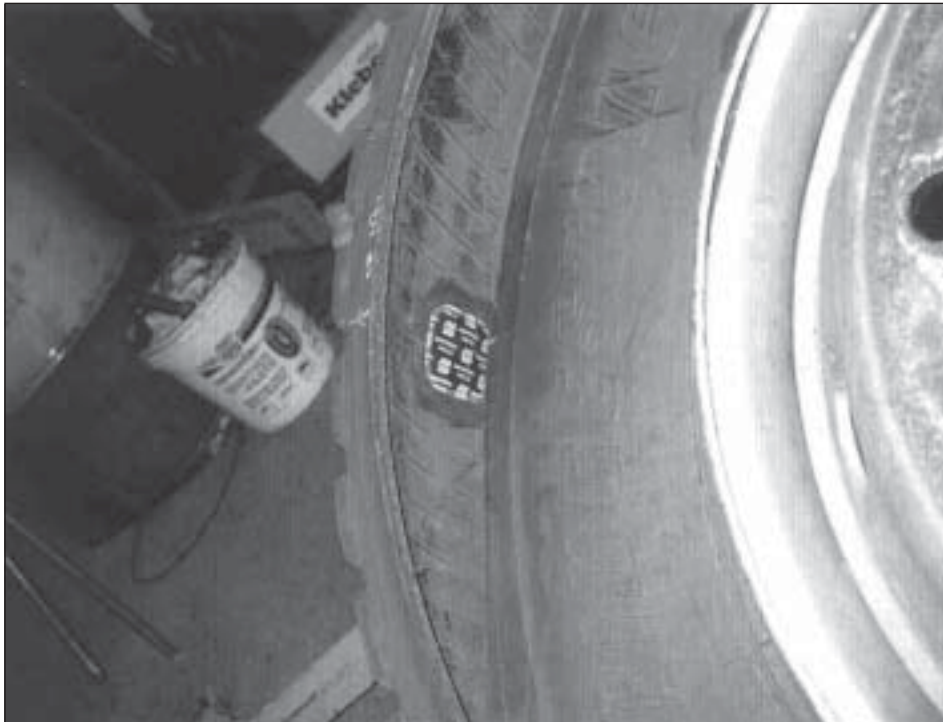
Kuva 2. Renkaan kylkeen räjähdyksessä syntynyt renkaan kehän neljäjäsen mittainen repeämä ja siitä näkyvä paikattu reikä.
