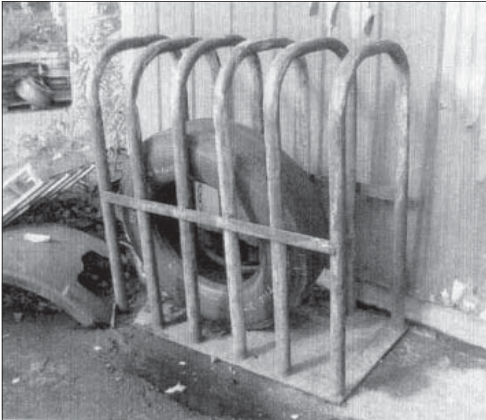
Kuva 3. Rengaskorjaamon hallin ulkopuolella piha-alueella sijainnut turvahäkki, joka ei todennäköisesti olisi antanut riittävää suojaa paineen purkautumista vastaan.
