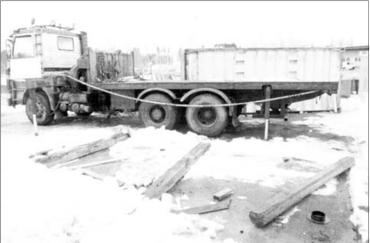
Kuva 1. Siirrettävä kontti (taustalla kuorma-auton takana) oli aluksi maassa etualalla olevien parrujen päällä, josta se oli tarkoitus nostaa kuorma-auton lavalle.
