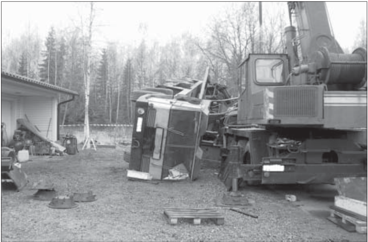
Kuva 1. Tukematon nosturiauto kaatui vieressä ollutta nosturiautoa vasten, kun NN nosti puomin pystyyn ja alkoi kääntämään nosturia.
