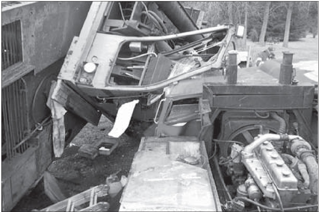
Kuva 3. Kaatuneen nosturin ohjaamo murskautui onnettomuudessa täysin. NN oli tapah- tumahetkellä ohjaamossa.
