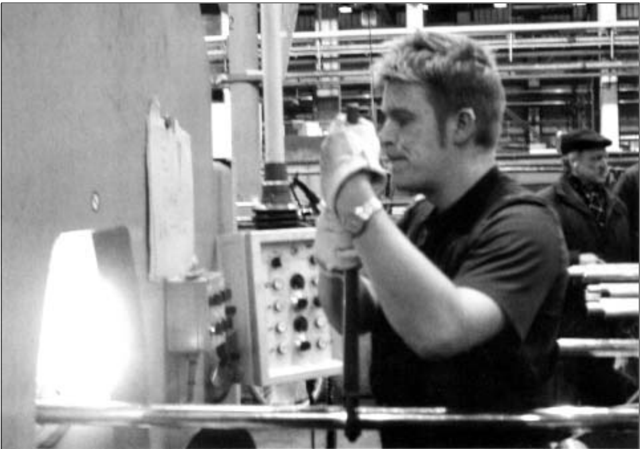
Kuva 2. Suprajohdetangon pään puristamisen toinen vaihe, jossa käytettiin avuksi putkitonkia.
