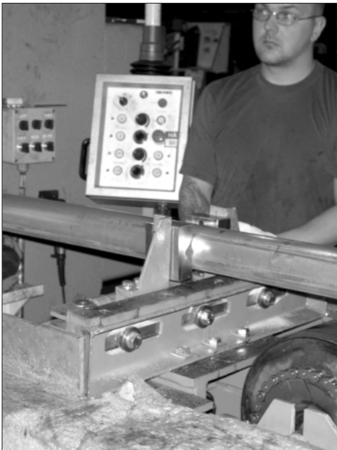
Kuva 3. Pääntekopuristin kuvattuna takaa. Keskellä puristettava suprajohdetanko.
