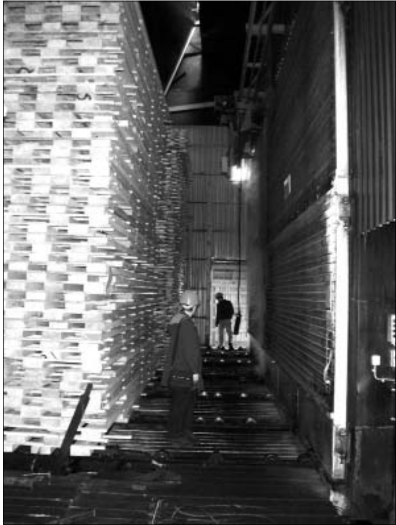
Kuva 5. Rimatornit ennen kuivaamoon (oikealla) siirtämistä. NN:n olisi pitänyt kiertää käytävää pitkin kuvassa vasemmalla ollut rimatorni ja mennä sen takaa vetämään vajjerilla paikalleen pysähtynyt rimatorni. Tämä tosin kuului kuivaamon henkilökunnan tehtäviin.
