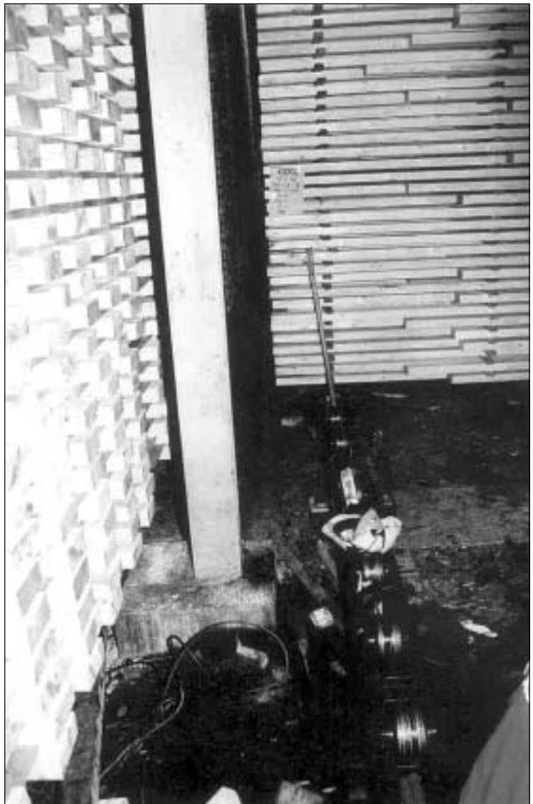
Kuva 2. Tapaturmakohta. NN jäi kuvassa keskellä olevan kannatinpalkin ja oikealla olevan rimatornin väliin. Rimatornia on työnnetty tapaturman jälkeen radalla ylöspäin. Lattialla NN:n vaurioitunut suojakypärä.
