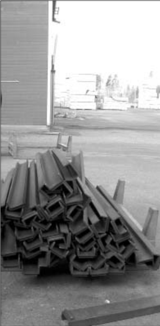
Kuva 1. Kuljetinalustoja. Aivan päällimmäinen alusta on hieman taipunut.
