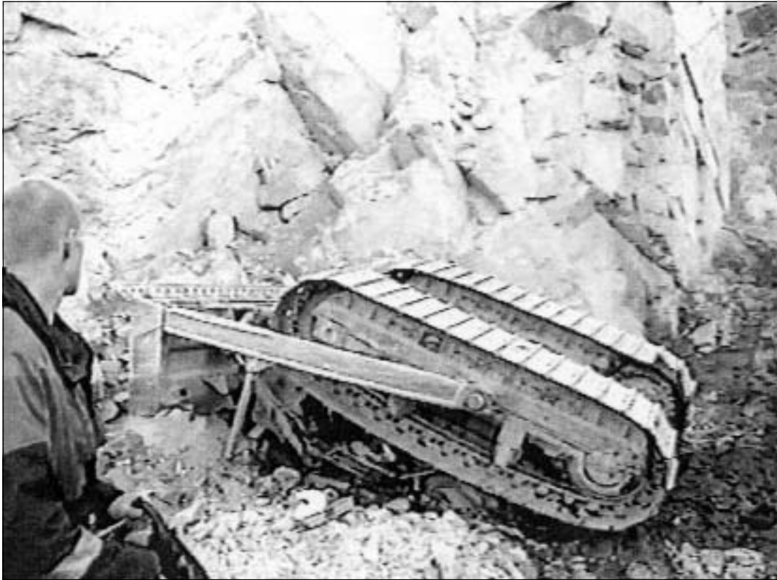
Kuva 1. Puskutraktori putoamispaikallaan, kuvattu tapahtuman jälkeen ennen koneen kääntöä.
