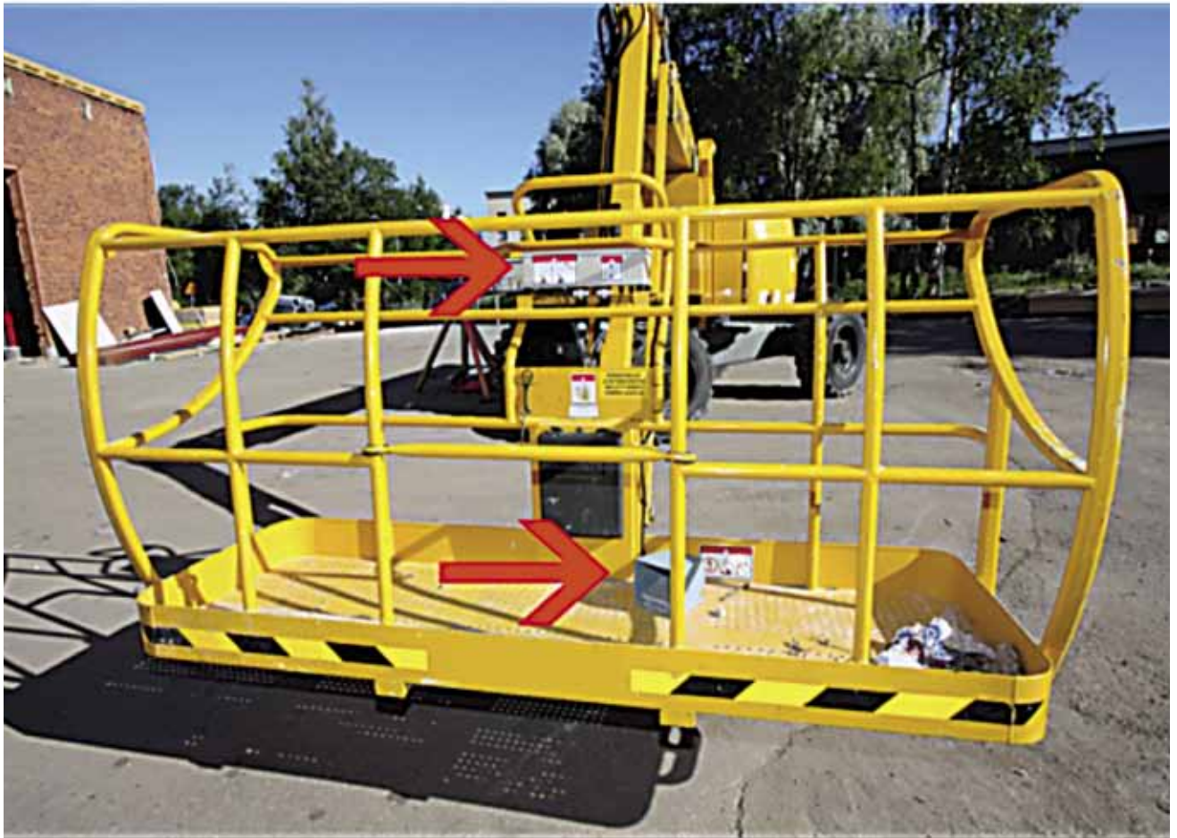
Kuva 3. Nostokori, jossa nuolet osoittavat käyttölaitteita ja poljinta.
