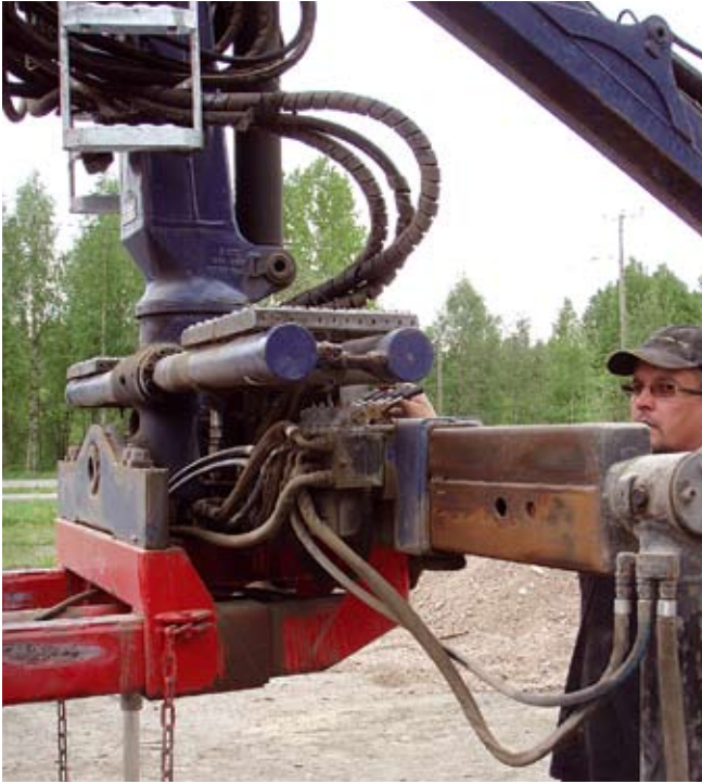
Kuva 2. Lavastus kuormausnosturin kiinnittämisestä hydraulisesti kuorma-auton perään siirtosylinterin avulla. Tätä työvaihetta NN ei tehnyt, mikä olisi edellyttänyt kuormausnosturin ympärikiertämistä 5 metrin matkan verran.
