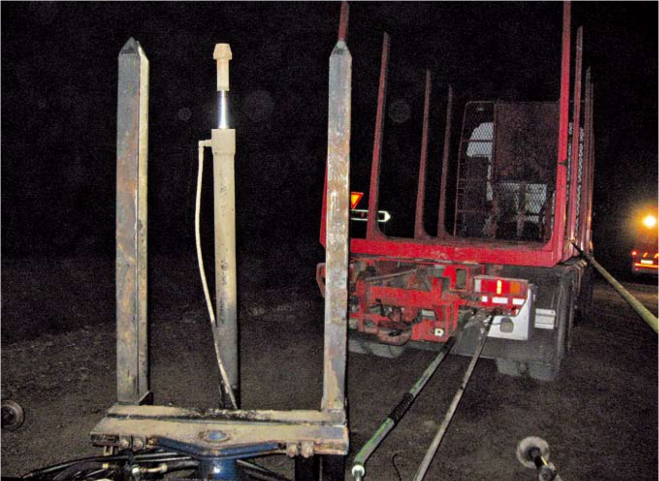
Kuva 4. Siirtosylinterin ja hydrauliletkujen asennot tapaturman jälkeen.
