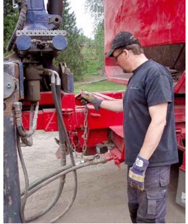
Kuva 3. Lavastus varmistusketjun asentamisesta siinä vaiheessa kun kuormausnosturi on kiinnitetty kuorma-auton perään peruuttamalla.
