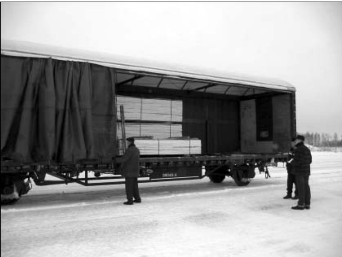
Kuva 2. Yleiskuva junavaunusta. Kuvassa siirretään lastin suojana ollutta sivusuojaa.
