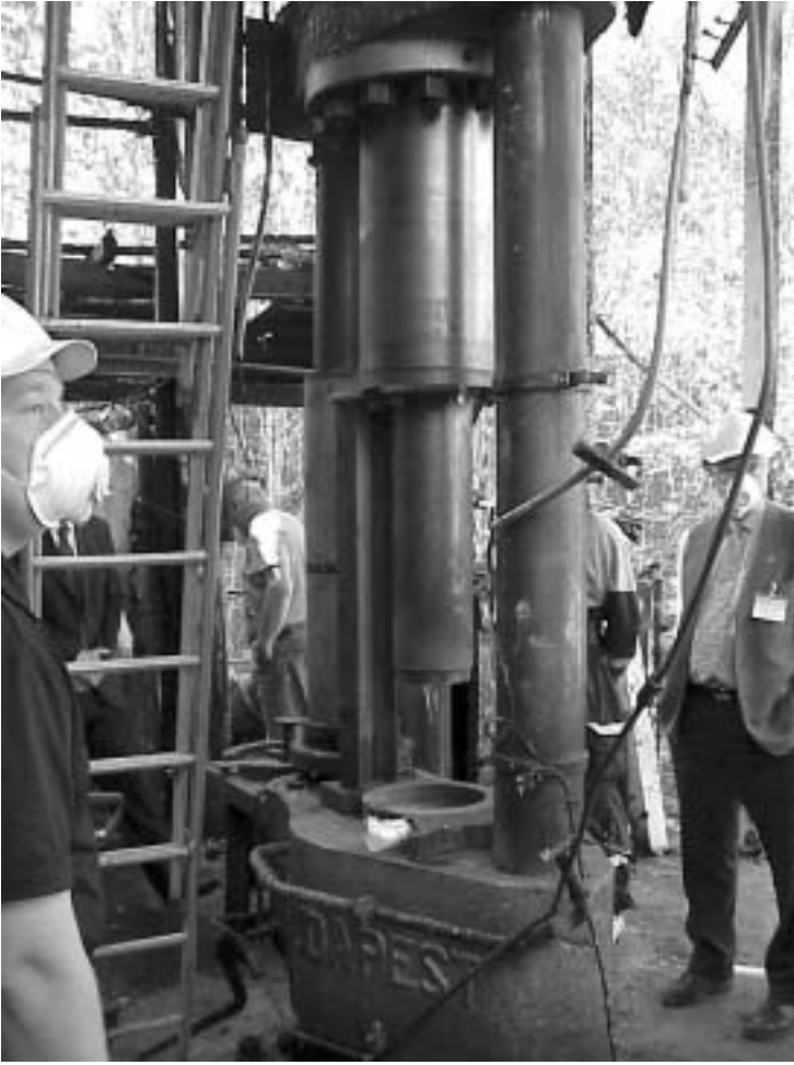
Kuva 3. Räjähdyksessä vaurioitunut puristin.
