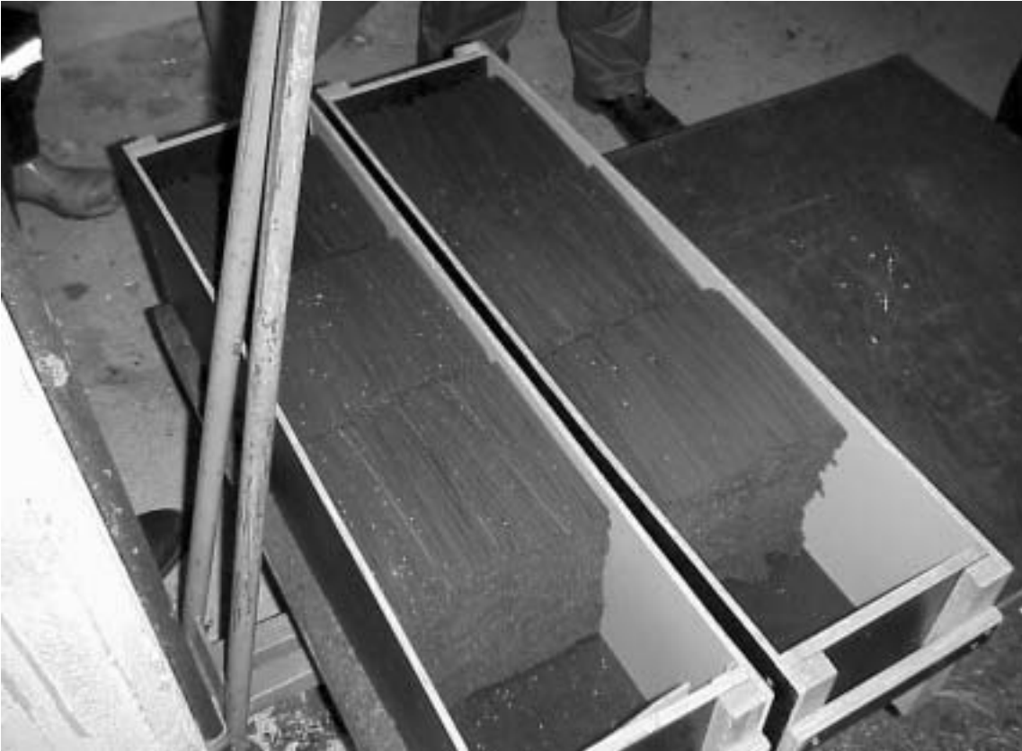
Kuva 1. Aamun aikana puristettu ruutierä laatikkoon pakattuna.
