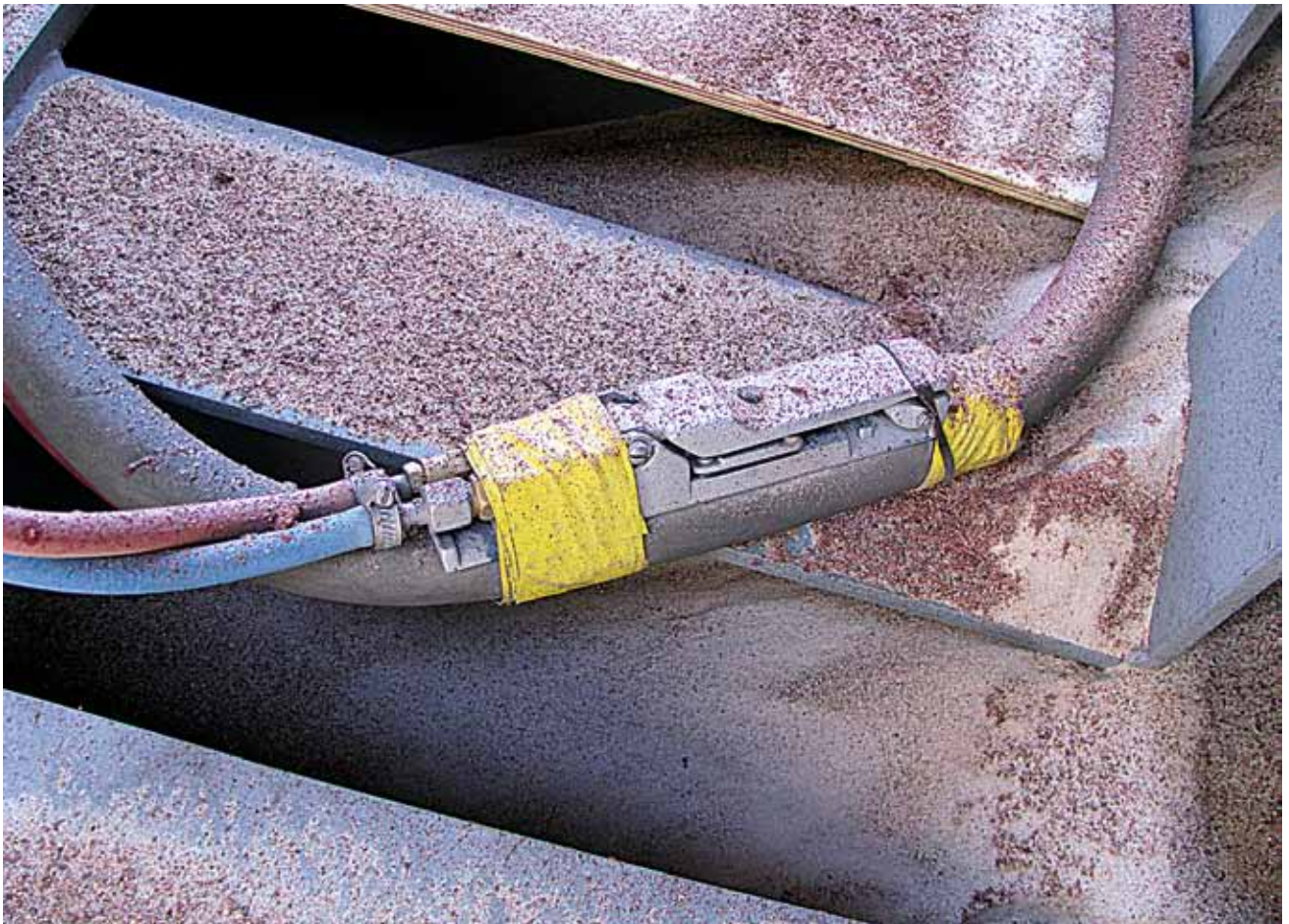
Kuva 2. NN:n käyttämän hiekkapuhaltimen turvakytkimen toiminta oli ohitettu lukitsemalla käyttökytkin kuminauhalla ala-asentoon.
