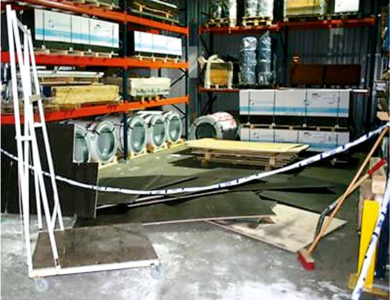
Kuva 1. Tapaturmassa kaatunut kuljetusrullakko tapaturman jälkeen.
