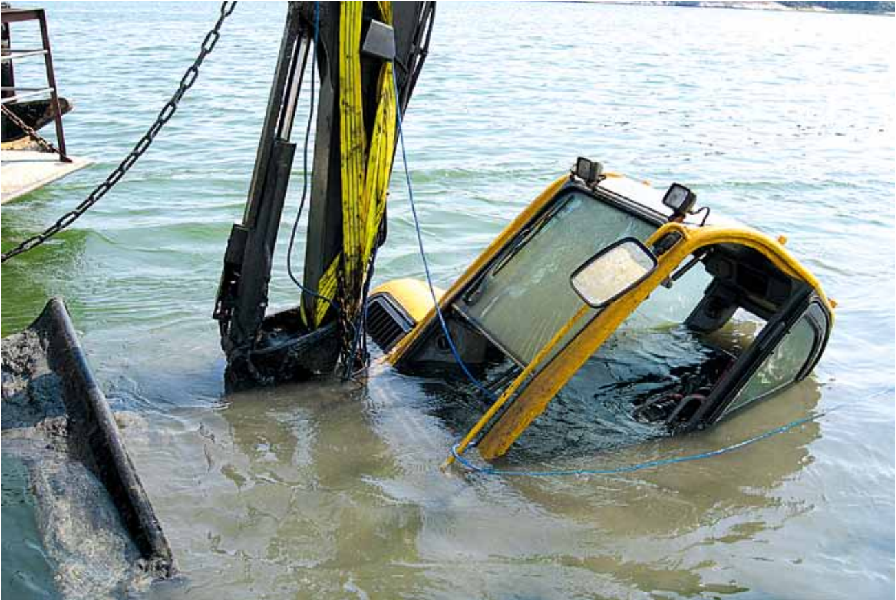
Kuva 4. Kaivukoneen nosto (huomattavasti tapaturmaa myöhemmin). Kaivukoneen ikkuna rikkoutui nostettaessa. Kuvasta näkyy, että NN on vetänyt penkin vieressä oven puolella olevan punaisen kahvan itseään kohti aikomuksenaan tulla ohjaamosta pois.
