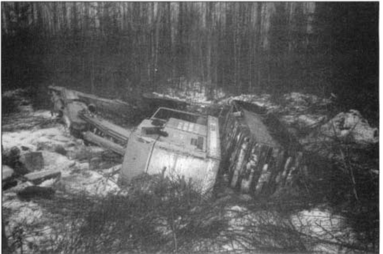
Kuva 1 ja 2. Kaivinkone kaatuneena vasemmalle kyljelleen.
