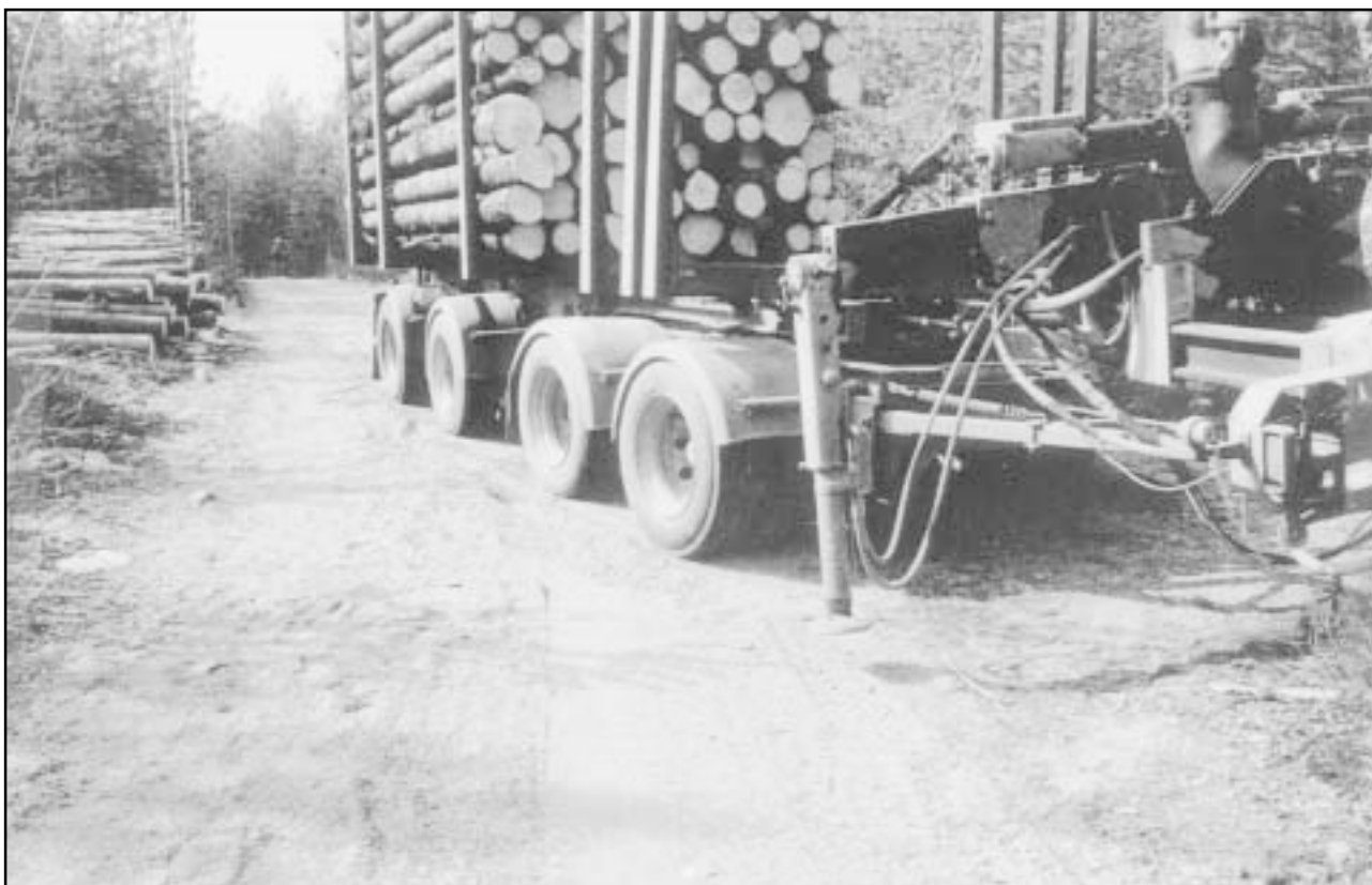
Kuva 4. Osittain ylösnostetut kuormausnosturin tukijalat.
