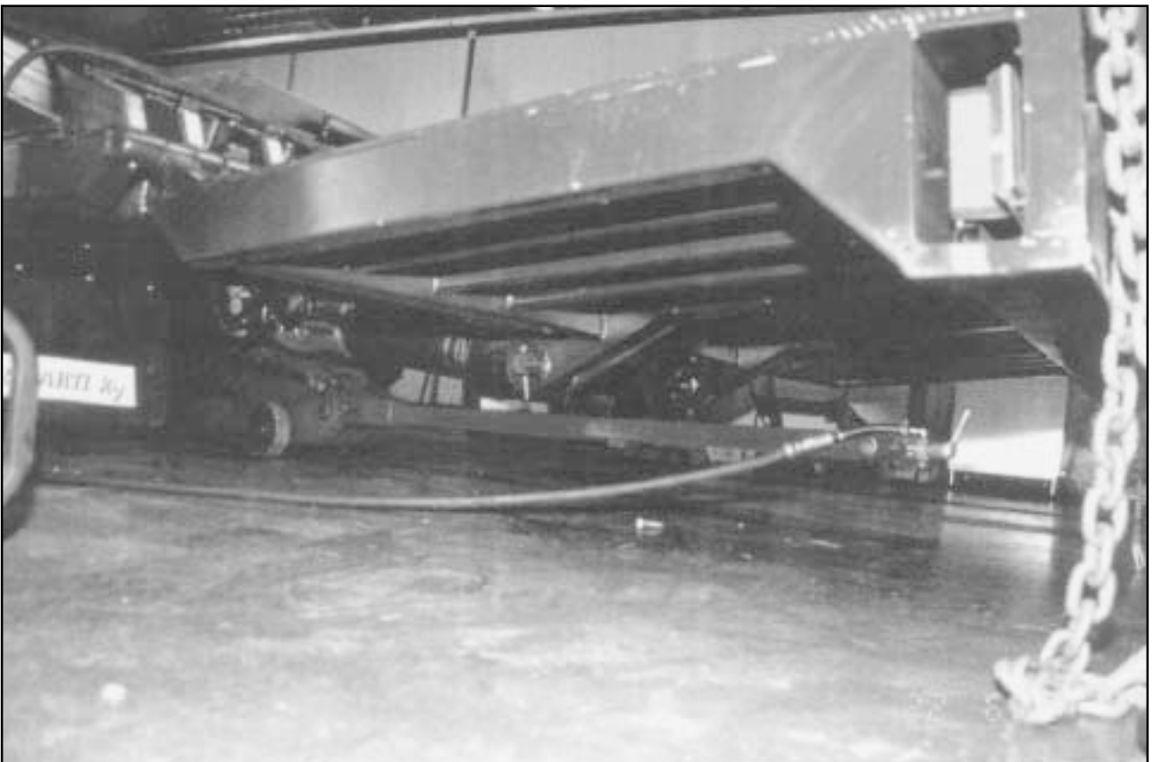
Kuvat 4 ja 5. Tunkki akseliston alla sivulta ja takaa kuvattuna.
