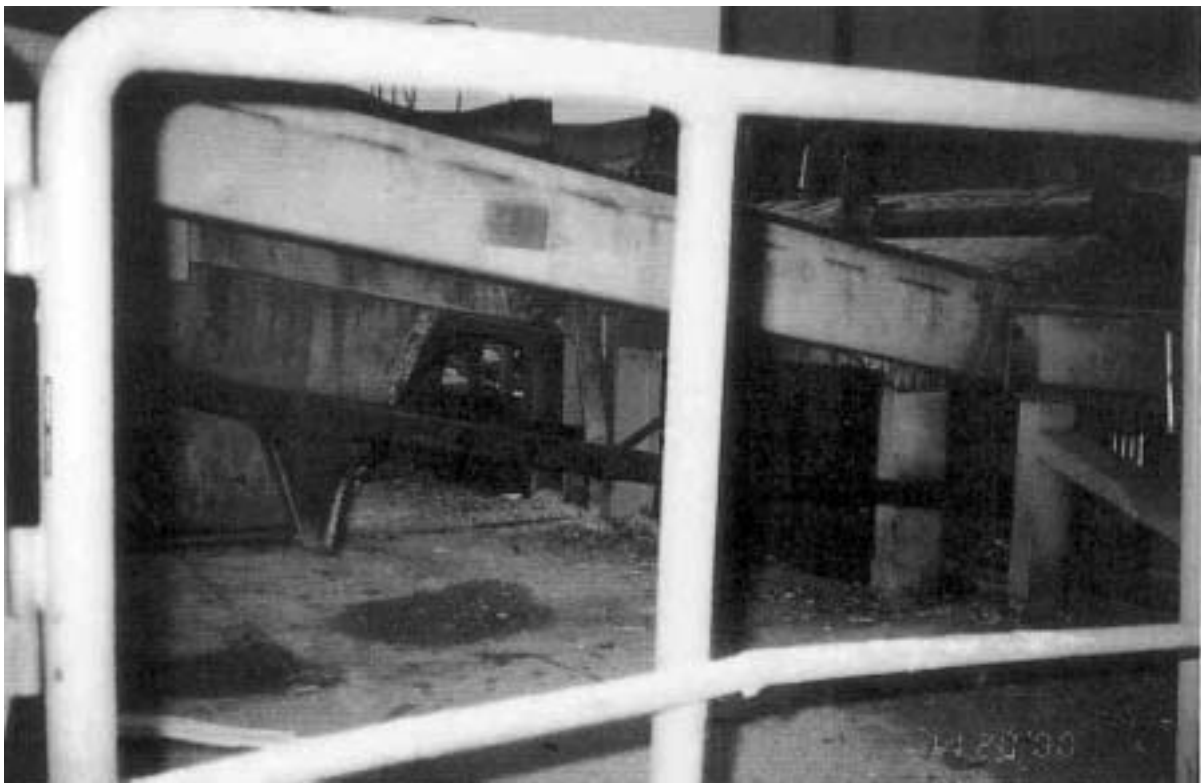
Kuva 2. NN:n ja RR:n käyttämä "nopea" kulkureitti aidan ja lajittelulinjan ympärillä olevan kiinteän suoja-aidan läpi. Turvaportin saranat näkyvät kuvan oikeassa reunassa.
