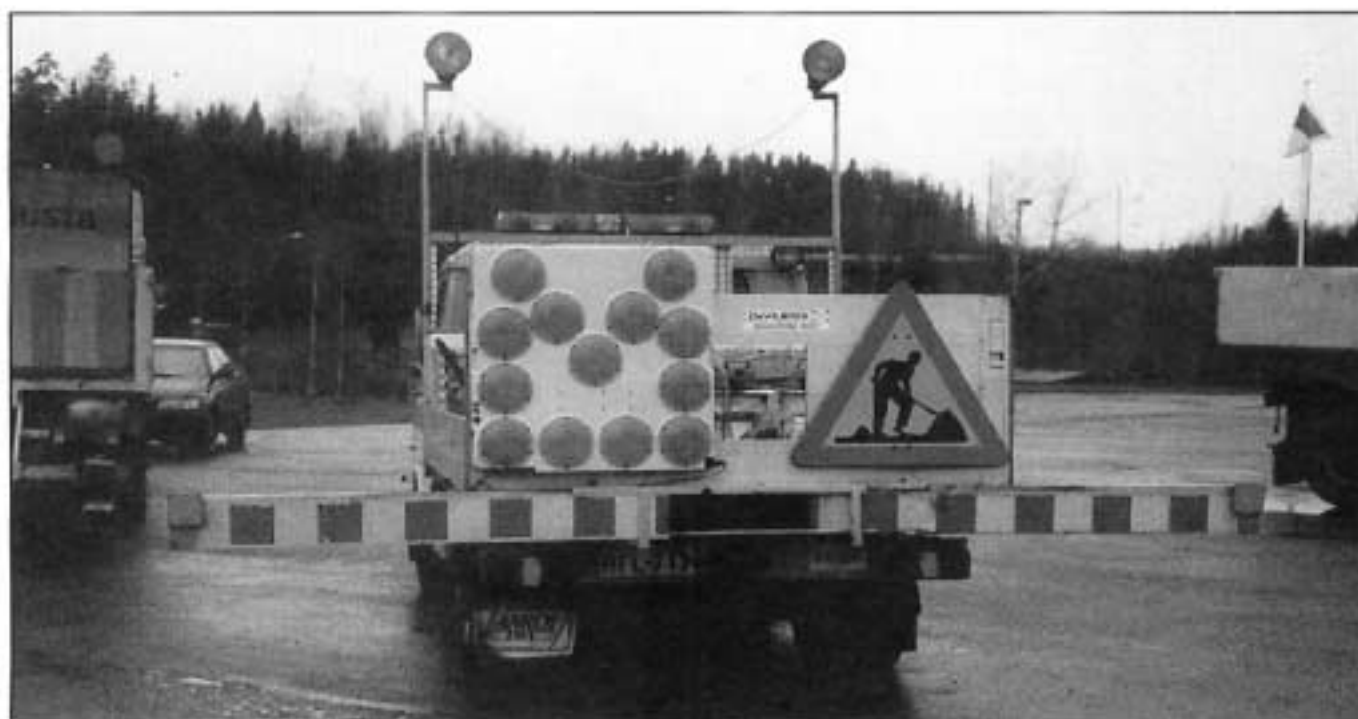
Kuva 2. Merkintäauton havaittavuutta voidaan parantaa ennen kaikkea lisäämällä varoitusvalaisimien määrää ja tehoa. Tieliikittäjiä voidaan varoittaa merkintäautoa leveämmällä olevasta etumerkintälaitteesta käyttämällä lavan perään rakennettua varoituspöydä, joka voidaan säätää etumerkintälaitteen puomin leveyden mukaan. Varoituspöydän päissä voidaan käyttää myös äärivalaisimia. Taaksepäin näkyvän äärivalaisimen väri on punainen. Merkintäauton perässä olevan liikenteenjakaja -liikennemerkin kokoa voidaan myös kasvattaa. Nuolen näkymistä voidaan tehostaa käyttämällä valonvoimaa.
