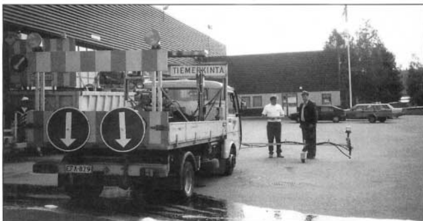
Kuva 1. Merkintäauton takalaidassa oli liikennemerkki, joka osoitti miltä puolen ajoneuvo piti ohittaa. Merkintäautossa ei ollut kuitenkaan liikennemerkkejä tai varoitustauluja, jotka olisivat varoittaneet etumerkintälaitteen leveydestä. Onnettomuuden jälkeen merkintäautoon laitettiin varoitustaiteita sekä suunnatut päivänäkkyvyysvaroitusvalaisimet. Etumerkintälaitteen havaittavuus oli huono. Matalalla lähellä tienpintaa olleessa etumerkintälaitteessa ei ollut varoitustaiteita tai muita varoitustauluja. Etumerkintälaitteen ulottumisesta merkintäauton leveyttä ulommaksi ei oltu merkitty varoituspöydillä tai millään muulla tavalla. Onnettomuuden jälkeen puomin havaittavuutta parannettiin varoitusvalaisimella.
