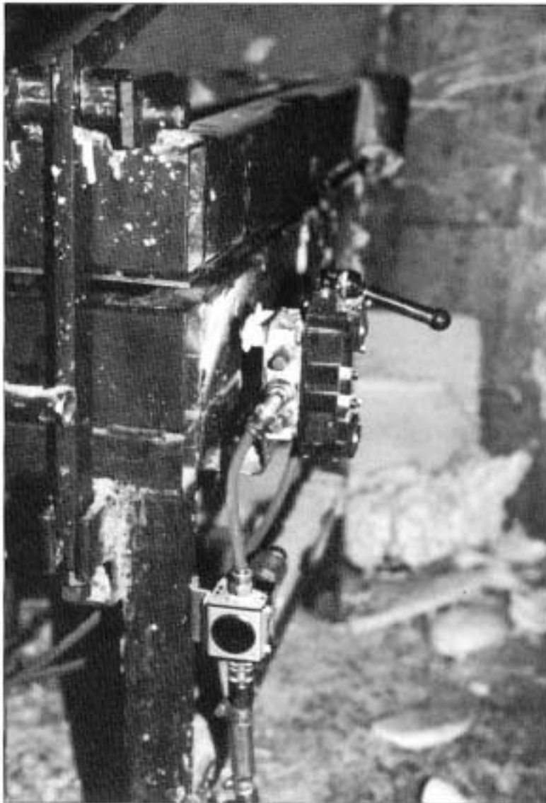
Kuva 3. Kansi avataan ja suljetaan koneen päähän itse asennetusta pneumatiikkaventtiilistä. Herkkäliikkeinen vipu sijaitsi suojaamattomana juuri sillä korkeudella, että NN:n jalka saattoi osua vipuun kurottamisen aikana.
