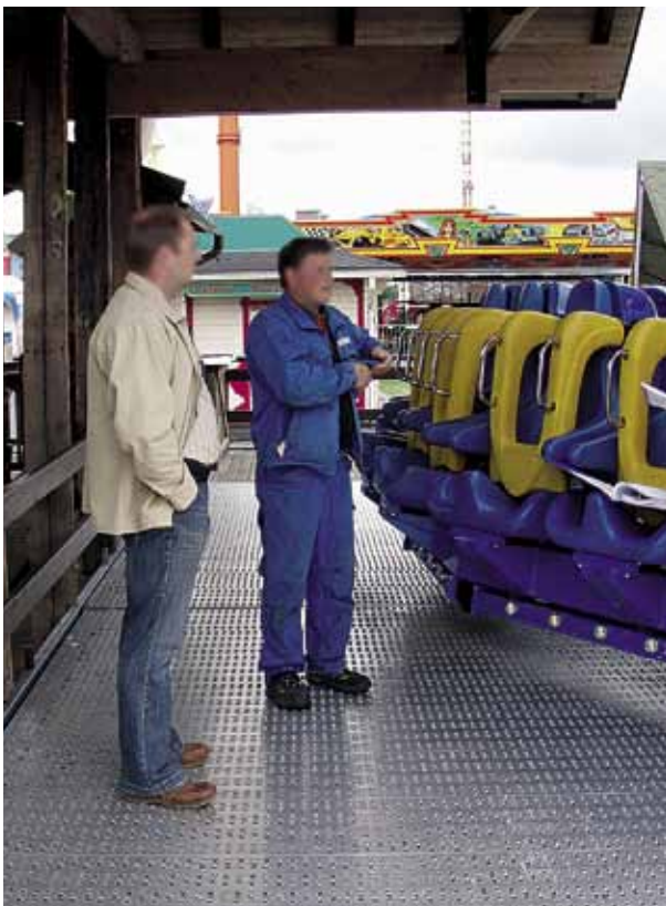
Kuva 6. Liikkuvan ja pyörivän laitteen ja kaiteen välinen kulkutie, jossa NN liikkui.
