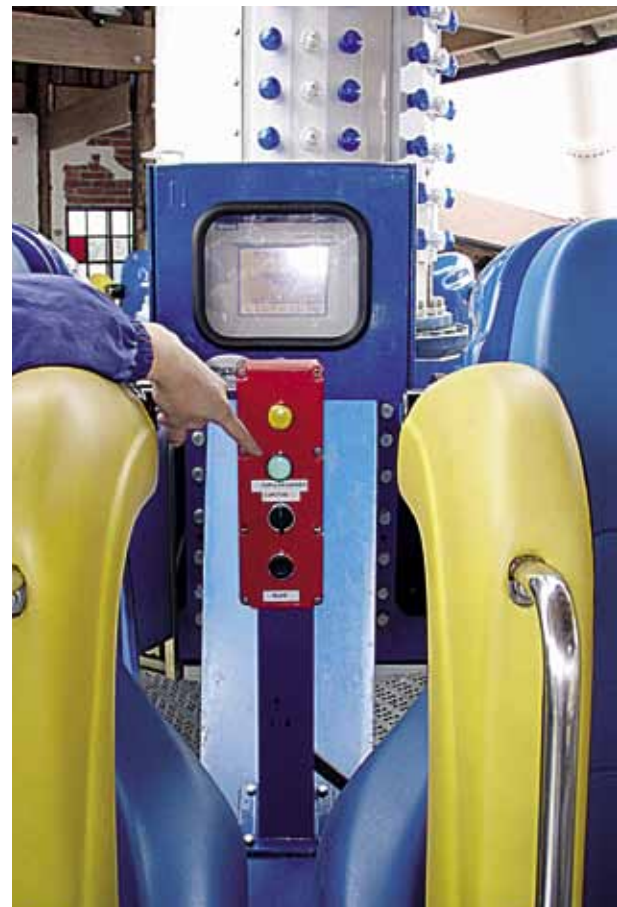
Kuva 5 Toimielin, jolla varmistettiin laitteessa istuvien henkilöiden turvallisuus.
