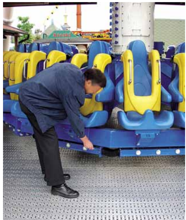
Kuva 7. Laitteen alla oleva metallipalkki, joka osui NN:ään.
