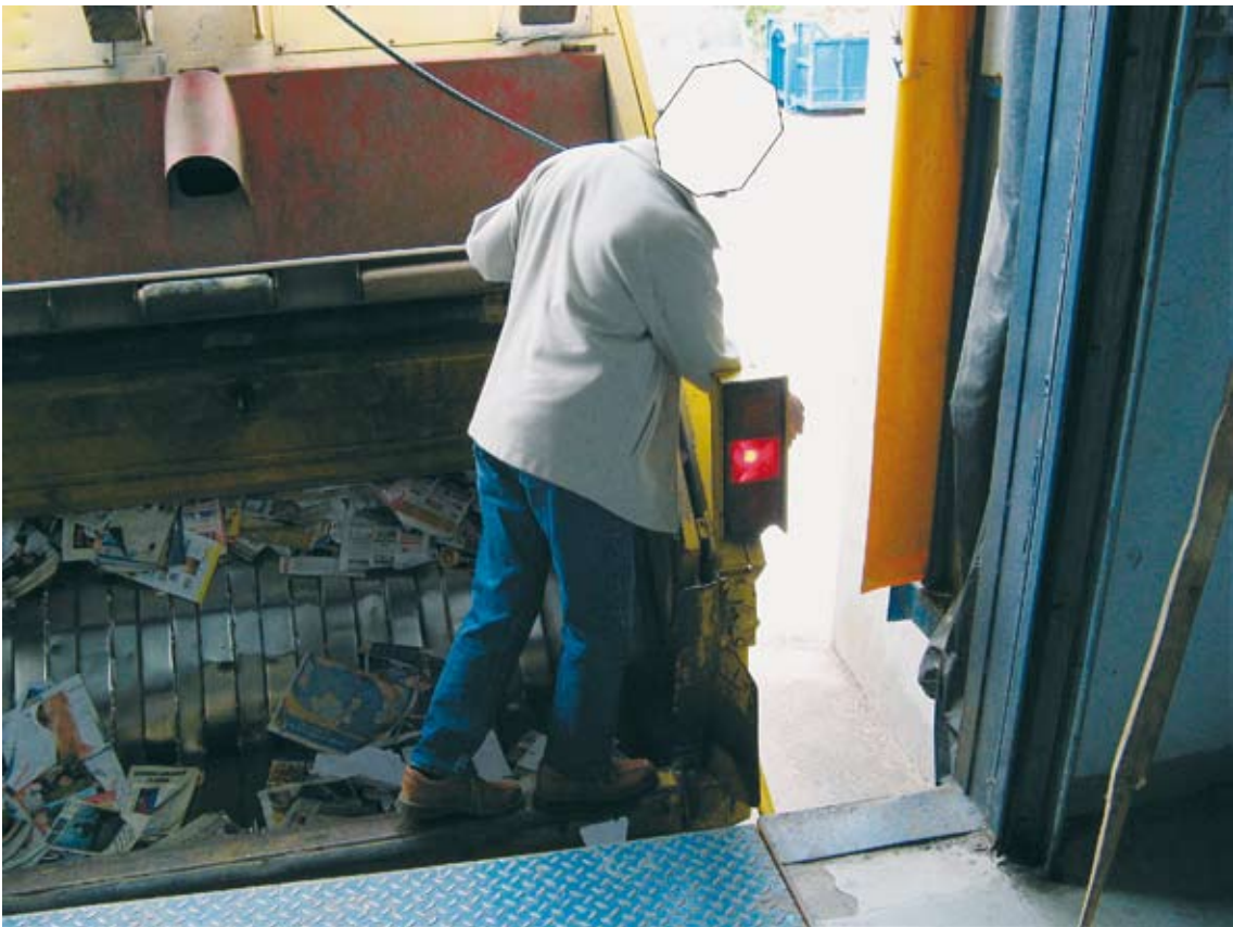
Kuva 4. Todennäköisesti NN käynnisti puristimen vakiintuneen työtavan mukaisesti kurkot- taen sen käyttökytkimeen lastauslaiturilta tai auton jättesäiliön reunalta.
