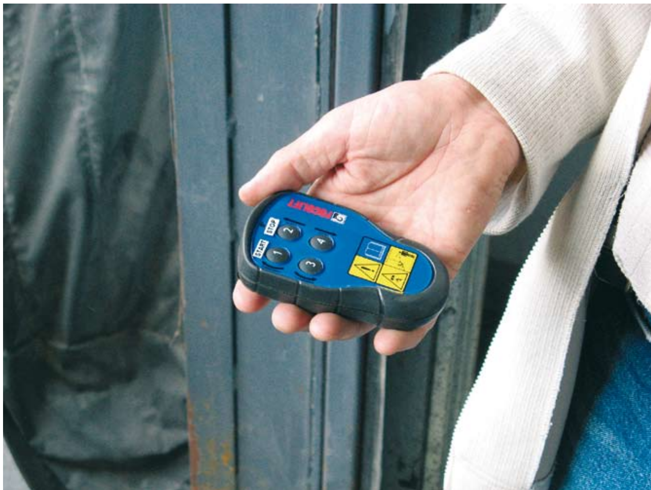
Kuva 5. Itse puristimen käytön turvallisuutta voidaan lisätä siten, että sitä käytetään kauko-ohjauksella vaara-alueen ulkopuolelta. NN:n ja MM:n käyttämä puristin varustettiin tällaisella toiminnolla tapahtuman jälkeen.
