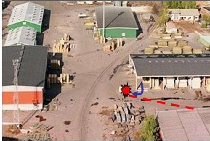
Kuva 1. Kuva tapahtumapaikalta. Laskettuaan nipun rullaradalle MM peruutti trukillaan kaartaen samalla vasemmalle 90° (sininen nuoli). Tällä välin NN oli ajanut pyörällään trukin ohi (punainen katkoviiva). Peruuttaessaan MM:n ohjaama trucki osui NN:ään (punainen tähtikuvio), joka kaatui asfaltille.
