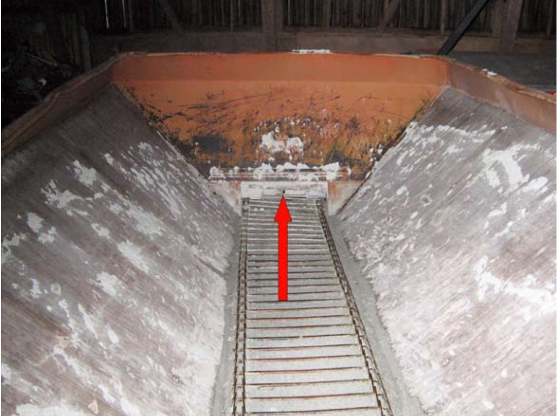
Kuva 3. NN ilmeisesti menetti tasapainonsa, jolloin hän joutui ja puristui vaunun pohjassa liikkuneen ketjukuljettimen (puikkoelevaattorin) mukana levitinaukkoon.
