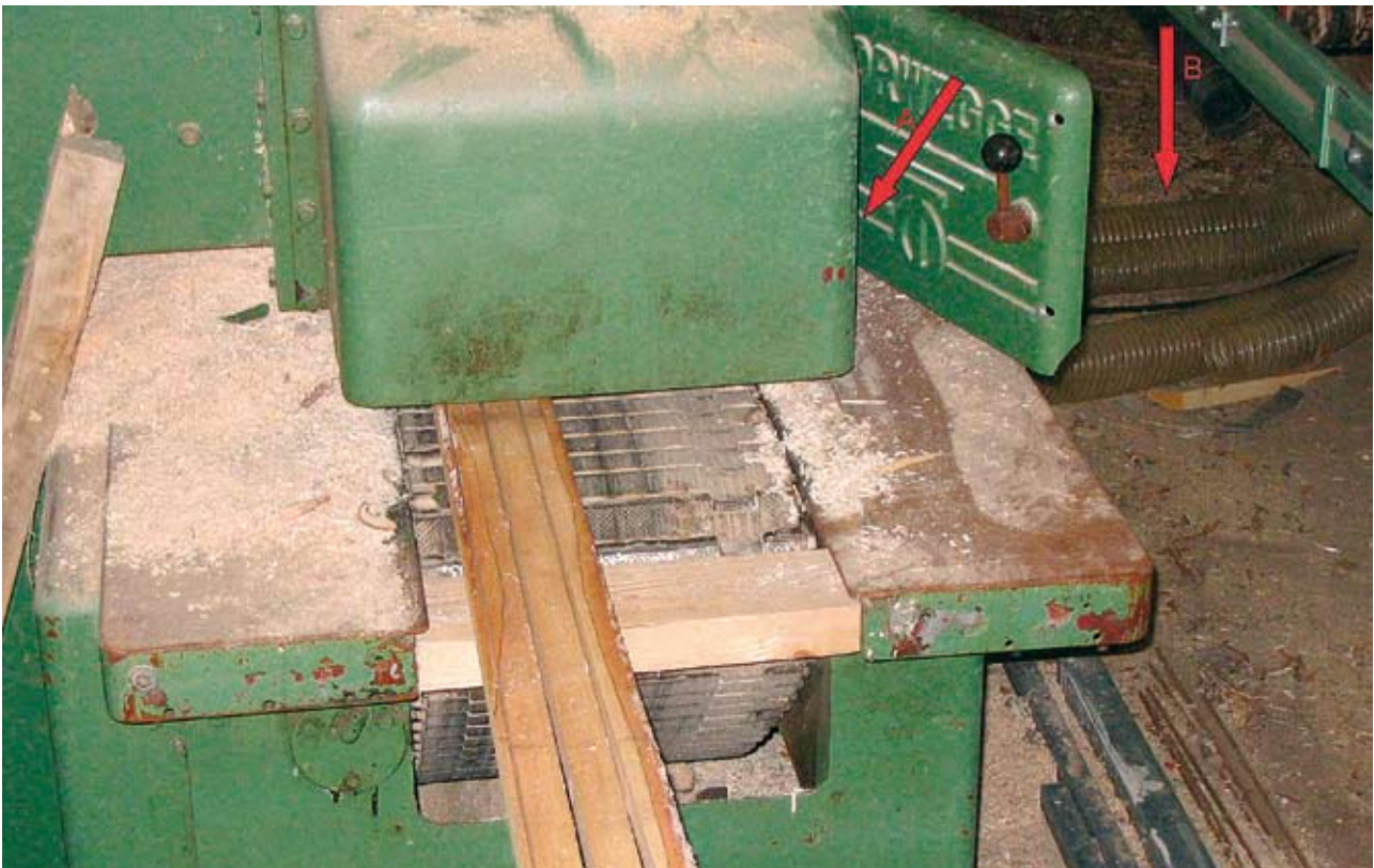
Kuva 2. On mahdollista, että aiemmin sahatusta soirosta irronnut ja sirkkelin sisään jumiin jäänyt puukappale tuli ulos seuraavan sahattavan soiron työntämänä koneesta olevasta suojaamattomasta aukosta (nuoli A). Tapahtumapaikka oli lisäksi ahdas ja osin epäjärjestyksessä (nuoli B).
