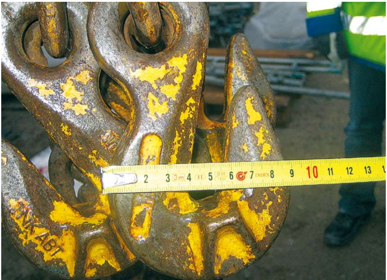
Kuva 2 Lähikuva lyhennyskoukusta, jossa koukun "suu" on n. 1,5 cm.
