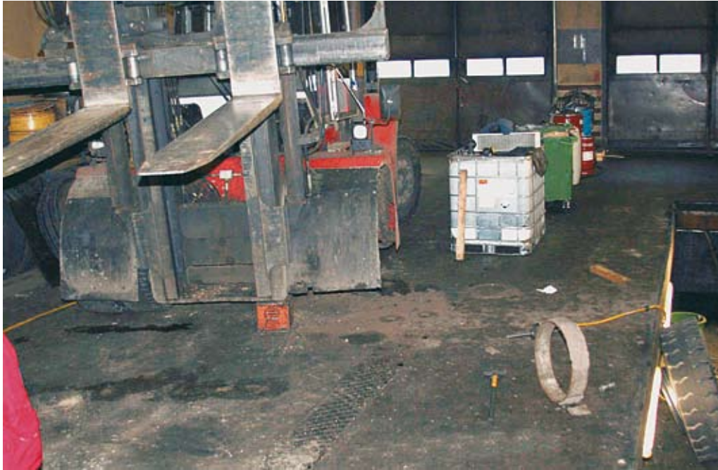
Kuva 1. NN oli vaihtamassa haarukkatrukkin vasenta etupyörää. Lukkovanteen asennusuran (pidäntinreunan) ohuen reunan murtumisen johdosta lukkovanne nousi pois urastaan, joka aiheutti rengaspaineen räjähdysmäisen purkautumisen.
