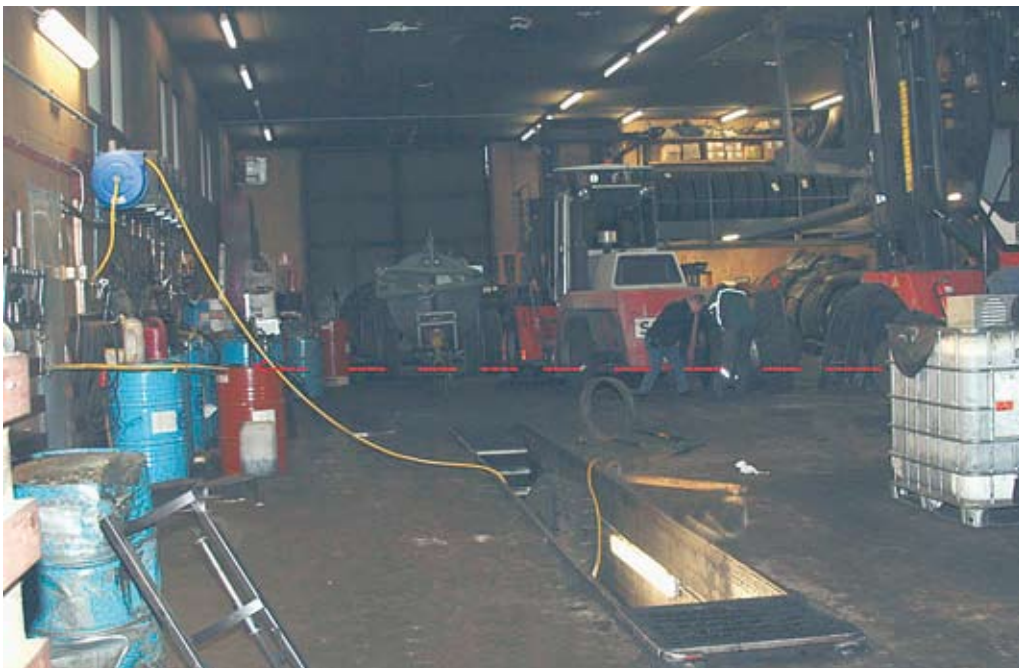
Kuva 2. Paineaalto lennätti NN:n 6,8 metrin päässä olleen hallin seinään. Myös pyörän lukkovanne ja NN:n renkaiden irrotuksessa käyttämä rautakanki sinkoutuivat räjähdysen johdosta hallin seinään (punaisen katkoviivan osoittama lentorata). Kuvassa rautakanki edelleen pystyssä ovelle.
