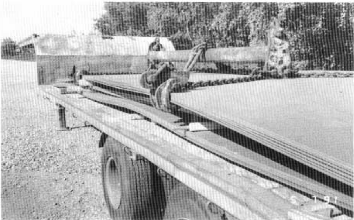
KUVA 2. Asianmukaiset nostoapuvälineet levypinoja nostettaessa. Onnettomuuden sattuessa käytettiin kettinkirakseja ilman tarraimia.
