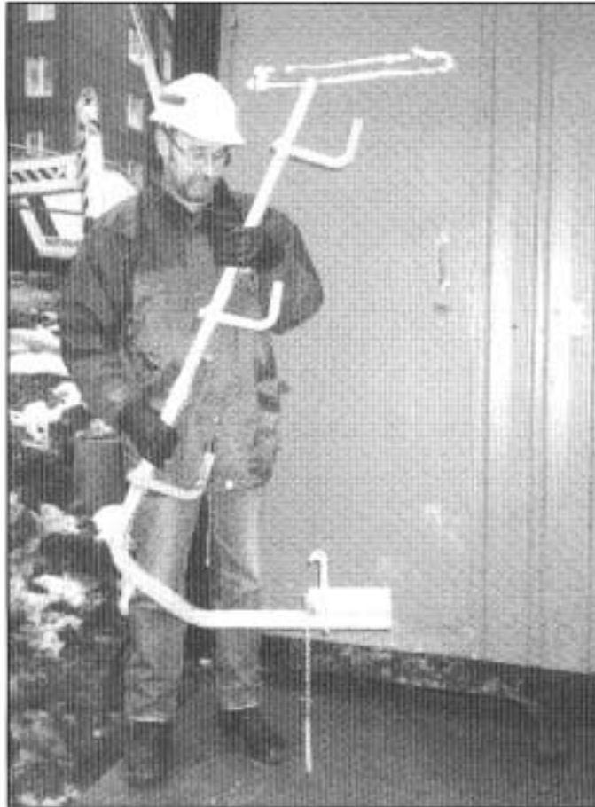
Kuva 1. Onnettomuuskaiteessa käytetty metallinen pystytolppa.
