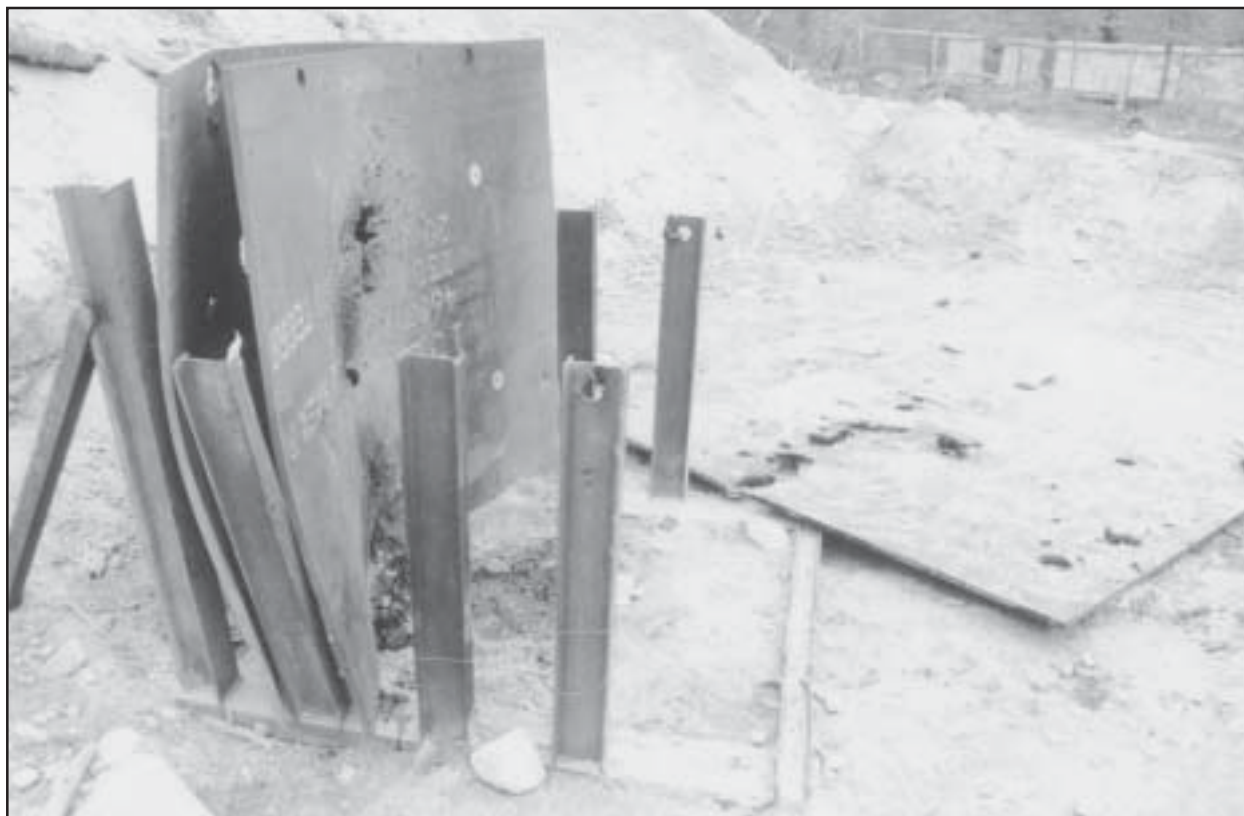
Kuva 1. Lähikuva maalilaitteesta oikealta sivulta kuvattuna. Maassa näkyvä teräslevy on ollut räjähdysen aikana etummaisten tolppien välissä ja NN kytkemässä kuvauspanosta kahden ensimmäisen levyn välissä.
