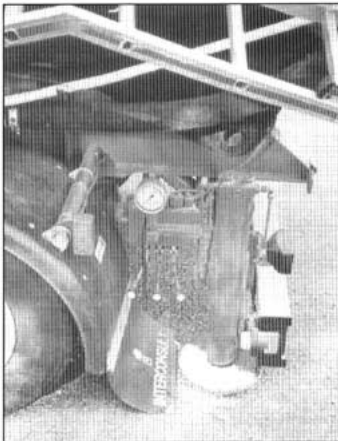
Kuva 2. Säiliöperävaunun kipin ja tukijalkojen hallintavivut perävaunun sivulla.
