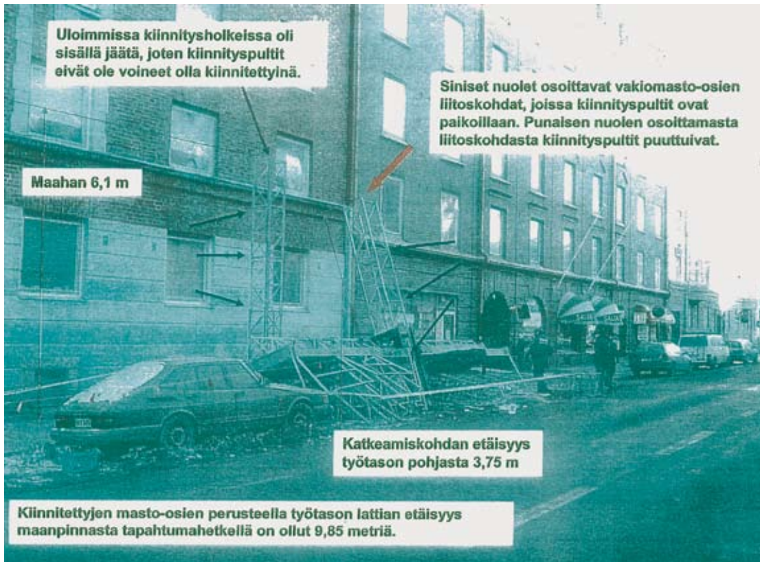
Kuva 2. Romahtanut mastonostin ja siihen liittyvät olennaiset mittatiedot.
