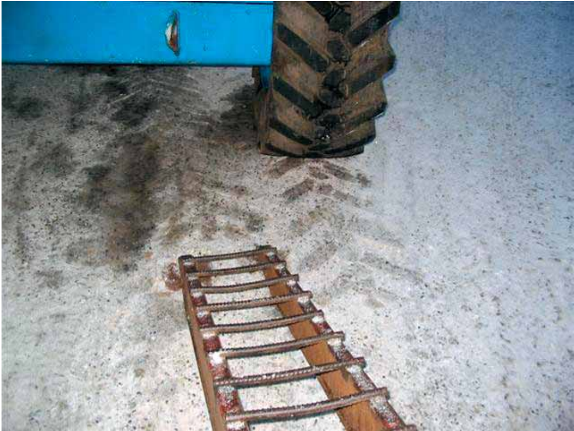
Kuva 3. Renkaiden kuviointi ja rampin puolat eivät muodostaneet riittävää kitkapintaa. Tapaus osoitti, että erityisesti talvikelissä tämä mahdollisti nostimen eturenkaiden luistamisen ja koneen hallitsemattoman liukumisen alas lavalta.
