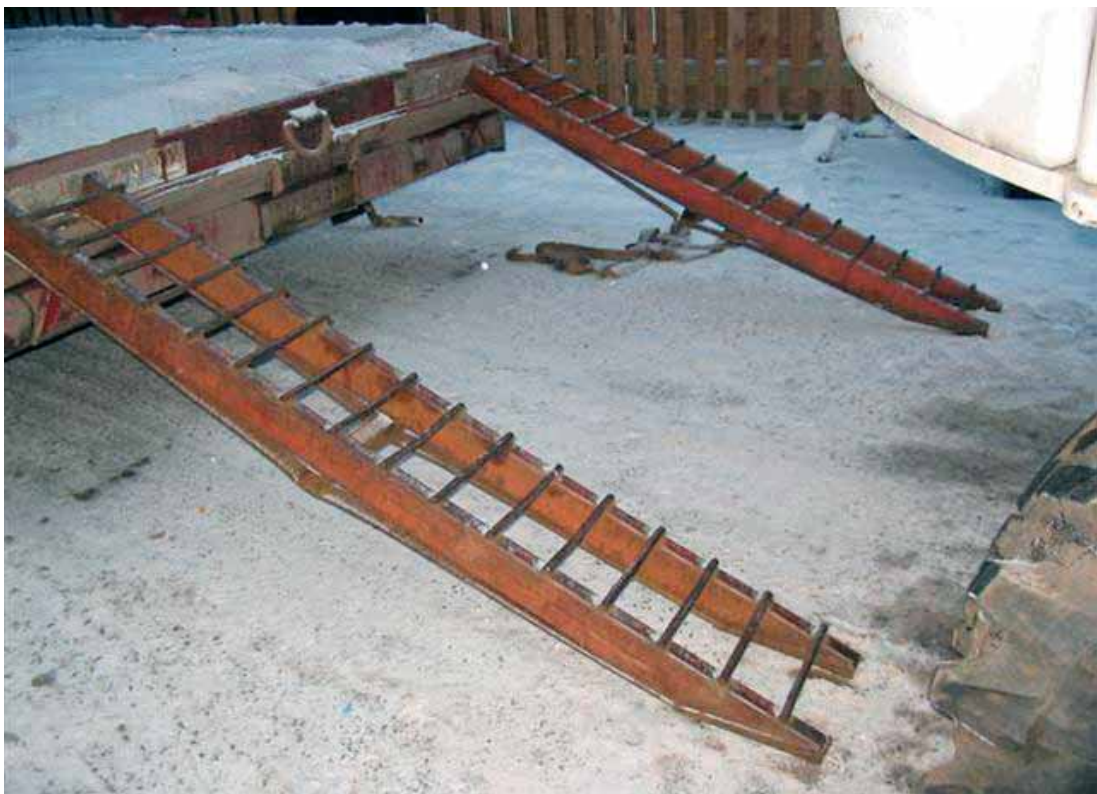
Kuva 2. Nostimen lastauksessa käytetyt rampit olivat tikastyypisiä, missä reisilankuina olivat I-palkit ja puolaosat olivat harjaterästä.
