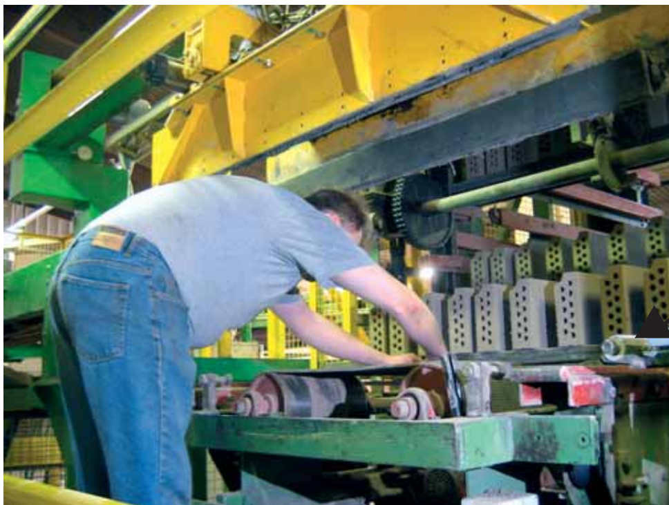
Kuva 4. Tilanne, missä tarttuja on lähtenyt alaspäin. Kuvan oikeassa reunassa näkyy rulla (ks. nuoli), jonka painaminen on voinut käynnistää liikkeen.
