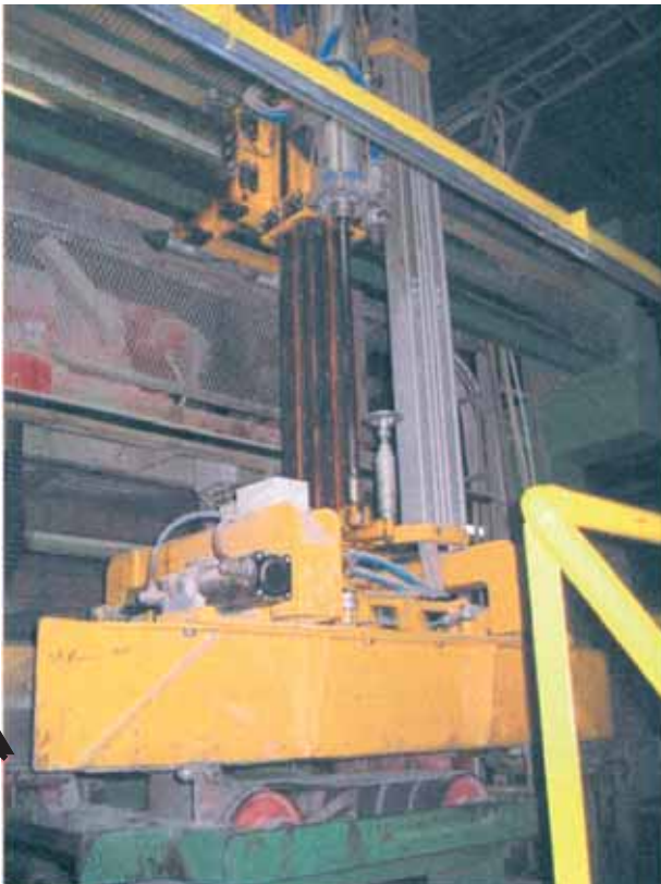
Kuva 2. Kuva on otettu tapaturman jälkeen ja siinä nähdään, että epäkeskosiirtäjän tanko (ks. kuvan nuoli) on taka-asennossa ja kuljettimen pyörien edessä oleva tukirauta on ylhäällä. Edellisessä kuvassa (kuva 2) nämä ovat normaalissa asennossa. Tapaturman sattuessa epäkeskosiirtäjän varren liike on siis keskeytynyt ja tämä on voinut aiheuttaa häiriötilanteen.
