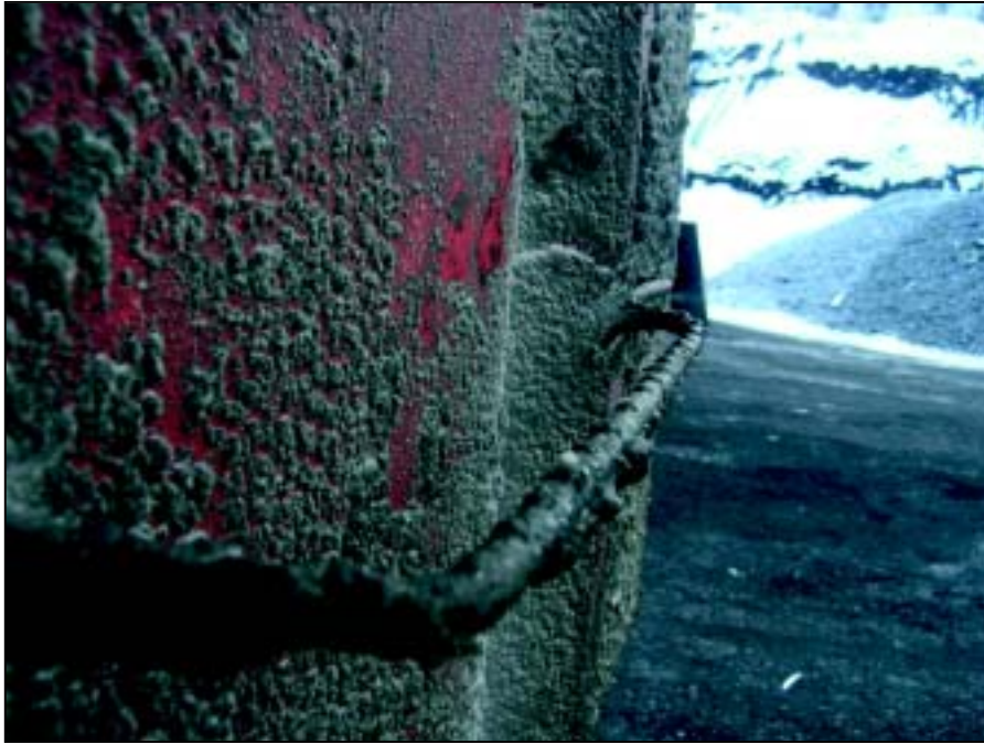
Kuva 2. Lavalle nousuun lavan etuosassa olevia askelmia pitkin liittyy putoamisvaara, sillä talvisista olosuhteista ja tikkaiden sijainnista johtuen tikkaat ovat usein jään ja lumen takia liukkaat.
