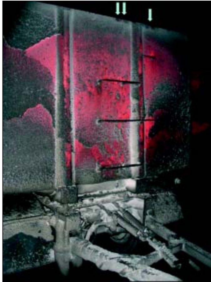
Kuva 1. NN nousi lavan etuosaan hitsattuja askelmia pitkin kantaen mukanaan muovista, neljän litran suolakanisteria. Jäljistä päätellen (nuolet) hänen otteensa oli livennyt lavan reunasta hänen noustessaan lavalle, jolloin hän oli pudonnut vetoauton ja perävaunun väliin ja osittain vetoaisan päälle.
