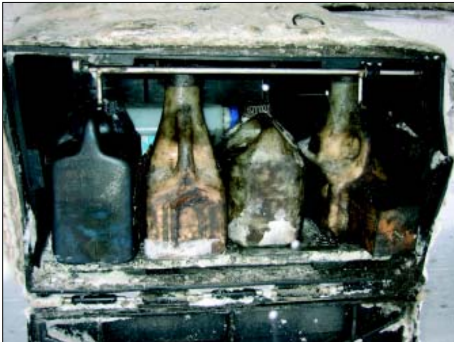
Kuva 3. Suolausastioina käytettiin käytöstä poistettuja öljy- ja pesunesteastioita. Niitä säilytetään lavan alla olevassa laatikossa. Kuljettajan siis täytyy kantaa toisessa kädessään astia mukanaan lavalle, jolloin kiipeäminen ei ole turvallista.
