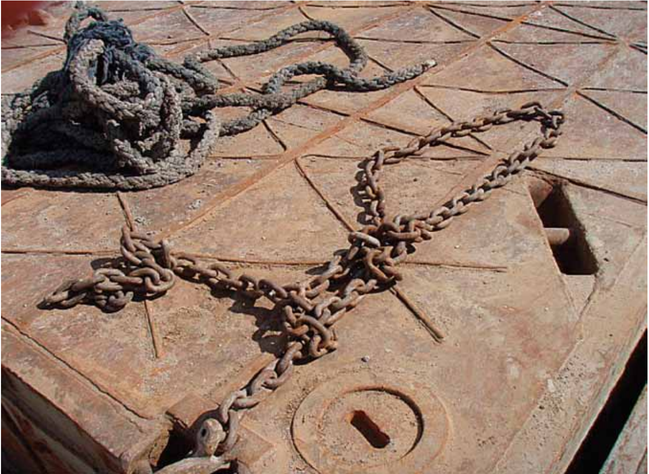
Kuva 3. Kuljetuslautan vetämiseen käytetty köysi ja kaivinkoneen kiinnittämiseen käytetty ketju kuljetuslautan kannella.
