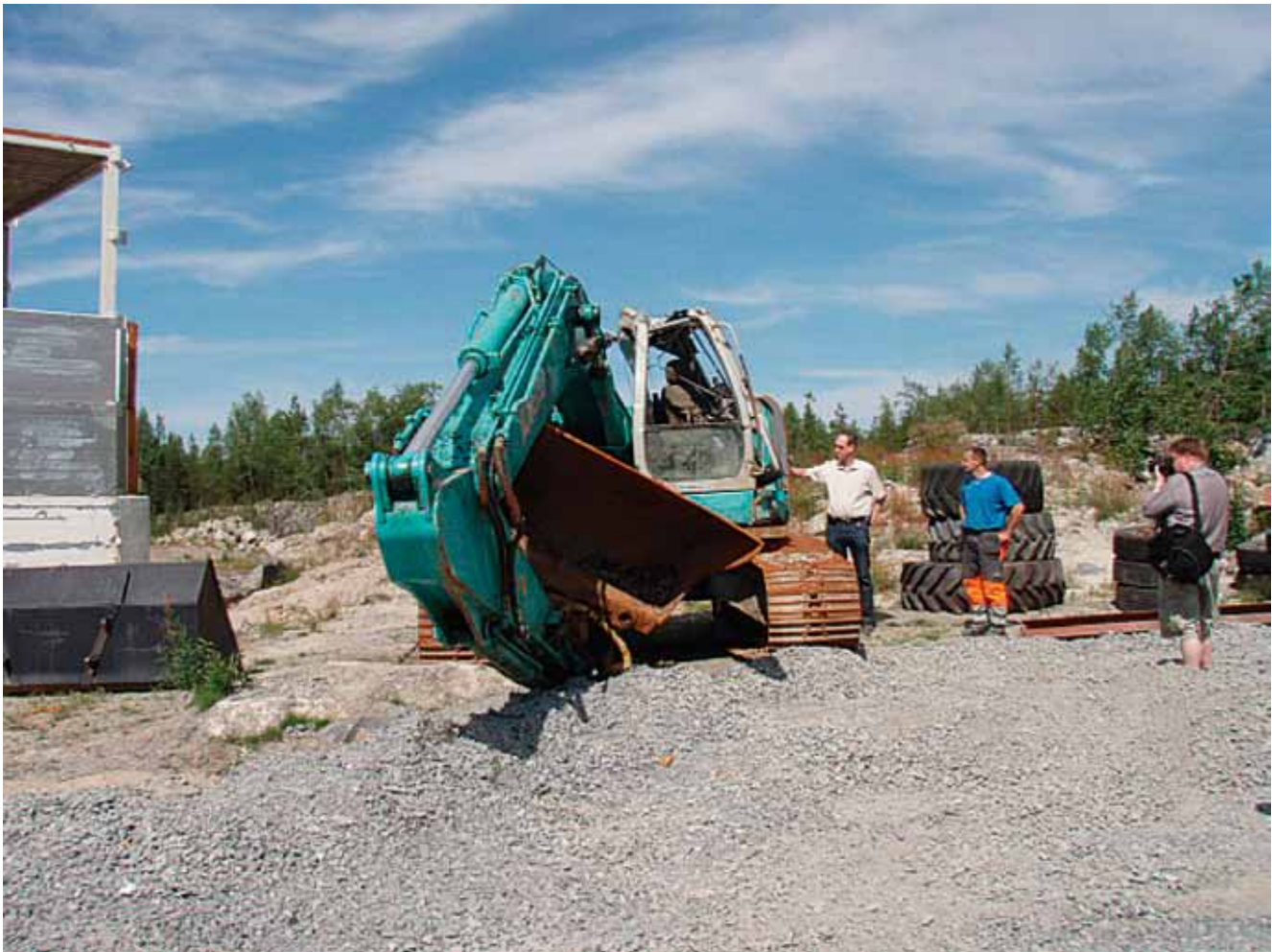
Kuva 4. Vaurioitunut kaivinkone rantaan kuljetuksen jälkeen.
