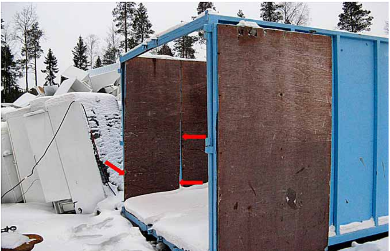
Kuva 2. Kuorma oli todennäköisesti lavaa kipattaessa siirtänyt vasemman laidan vaneria siten, että se esti saman puolen luukun sulkeutumisen.
