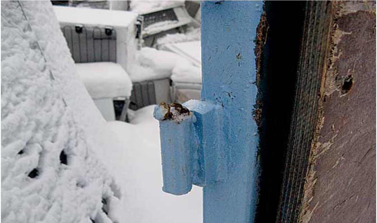
Kuva 3. Tapaturman aiheuttaneen vasemman takaluukun keskimmäistä saranaa oli korjattu jo aiemmin, ja sen tappi meni poikki NN:n sulkiessa ovea voimallisemmin. Kuvassa 2 osoitettu vanerin siirtymä näkyy myös tässä kuvassa.
