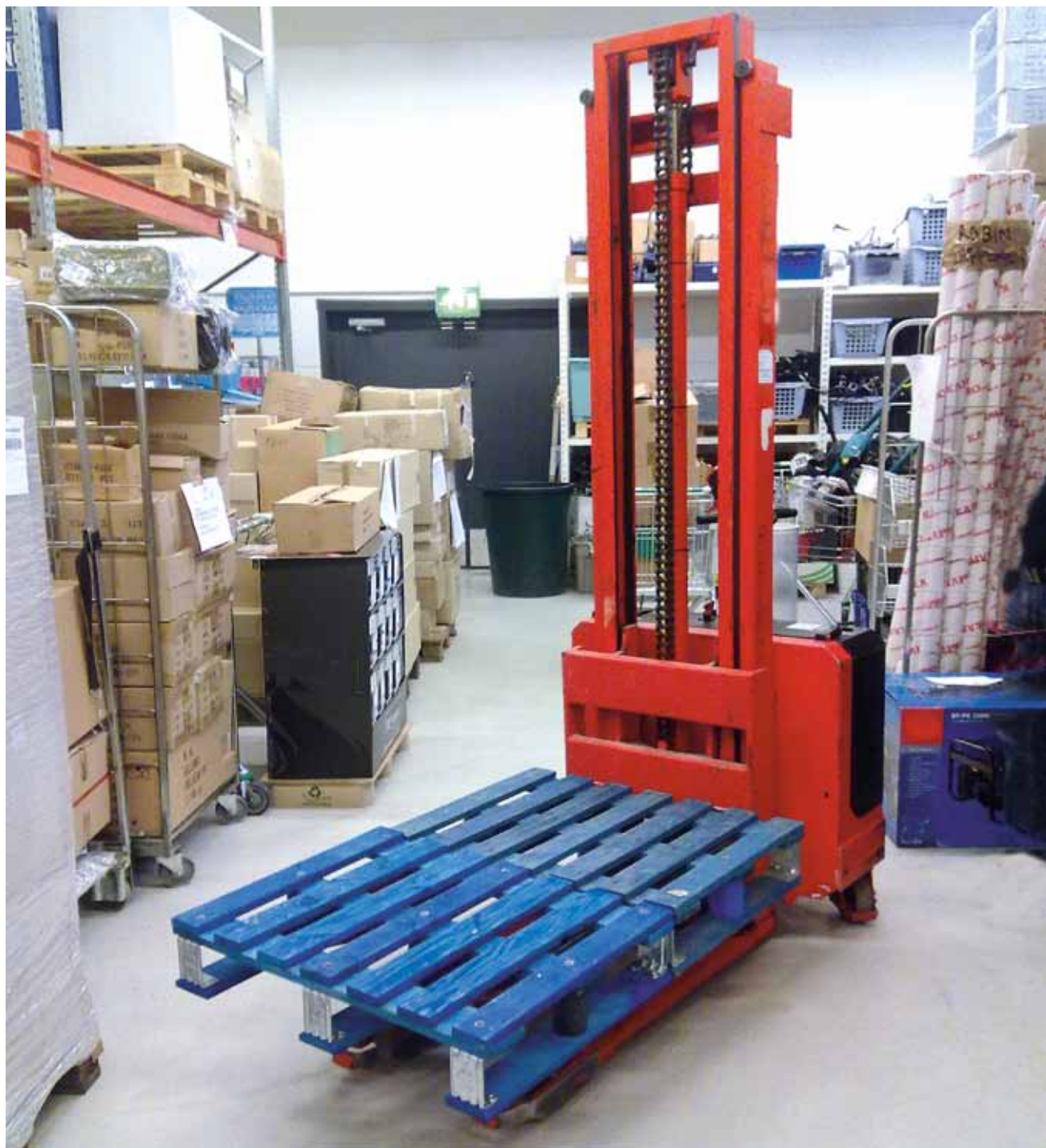
Kuva 1. NN pyysi MM:ää nostamaan hänet kohteeseen pinoamisvaunulla, jonka haarukkaan miehet asettivat kaksi puolikasta kuormalavaa.
