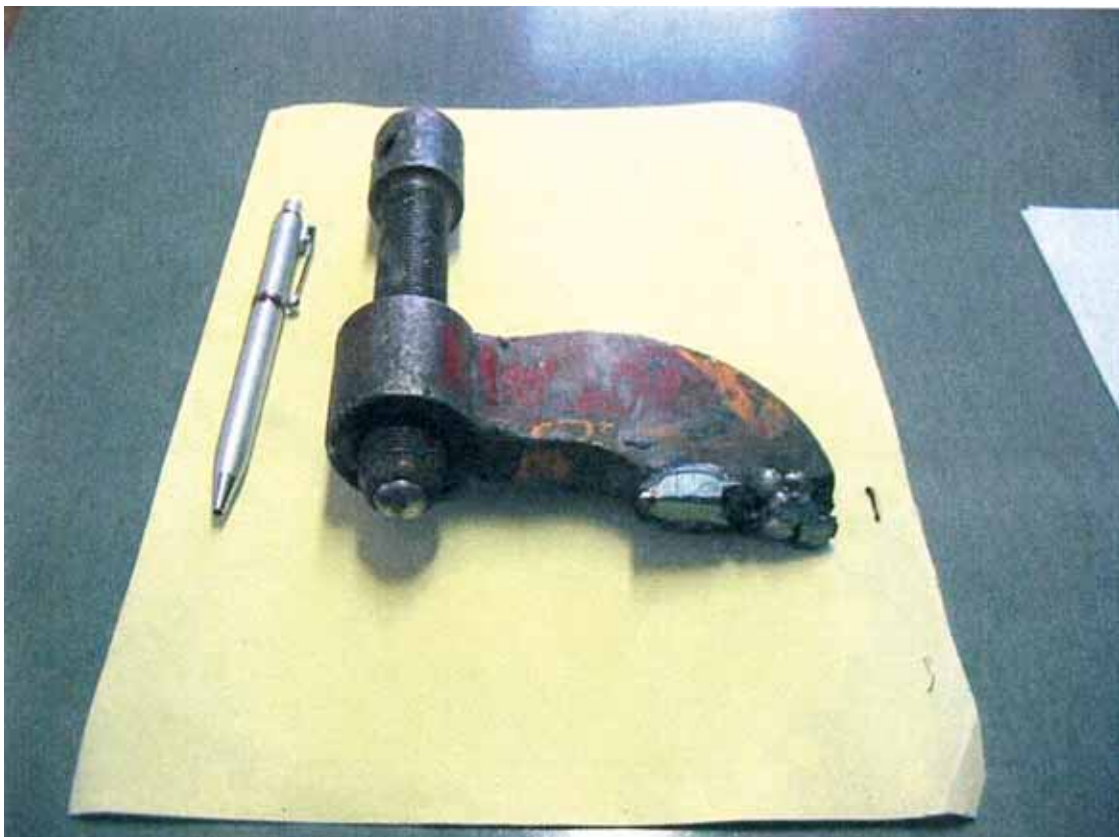
Kuva 2. NN:n käyttämä hitsauspuristin, jonka nokkaan hitsattua kärkeä hän oli jo ehtinyt hiomaan ennen tapaturmaa.
