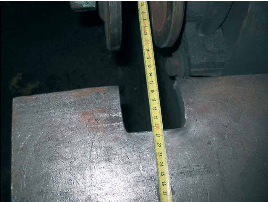
Kuva 1. U-muotoinen hiontatuki, jonka loven mitat ovat n. 55 mm (syvyys) x 75 mm (leveys).
