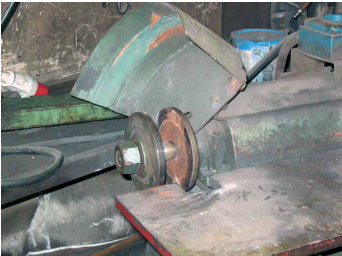
Kuva 4. Tapaturmassa sivuun vääntynyt rikkomasuojus.
