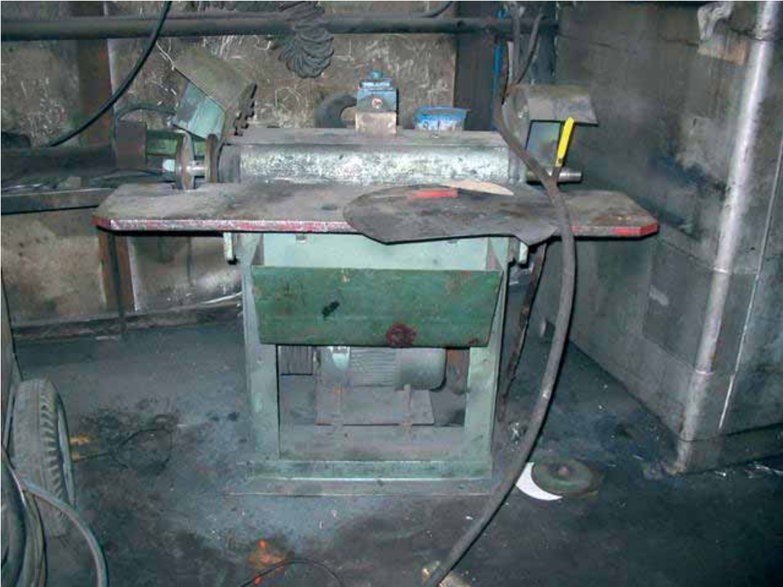
Kuva 3. Penkkihiomakone tapaturman jälkeen. Tapaturmassa hajonnut kivi oli vasemmassa päässä konetta.
