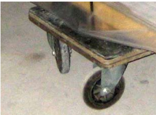
Kuva 3. Taakan siirrossa apuna käytetty pyörillä varustettu siirtoalusta.
